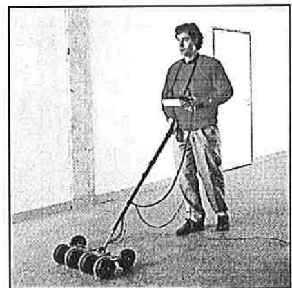
4. ábra. Mérés kerékes elektródból álló mérőfejfel
