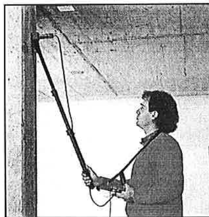
3. ábra. Mérés rúdelektrodos fejfel
