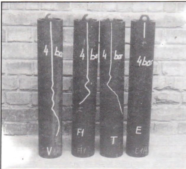
3. ábra A módosított Robertson vizsgálat során, 4 bar nyomáson létrejött repedések különböző gyártmányú, második generációs anyagú csöveken
