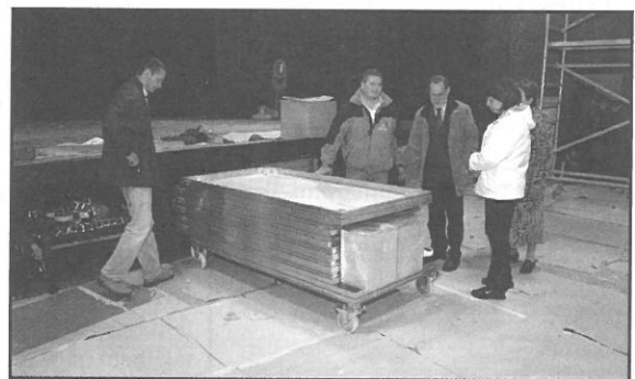
Ezek a mobil elemek a színpad bővítésére szolgálnak, használat után egyszerűen betolják őket a színpad alá
