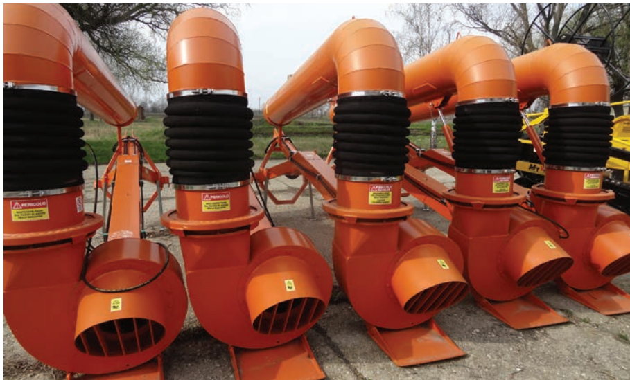
8. kép. Traktor-TLT-hajtású telepíthető átemelőszivattyúk
