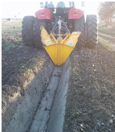
5. a-b kép. A csatornanyitó adapterek szabályos trapéz keresztmetszetű szelvényt nyitnak
