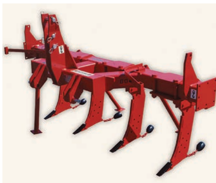
3. kép. Korszerű mélylazító-konstrukció és a vakonddrénes megoldás
