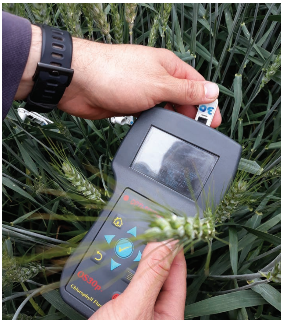
3. kép. A növény fotoszintetikus hatékonyságát mutatja a klorofill fluoreszcenciát mérő műszer. Az adatokból a növény vitalitására következtethetünk (fotó: Takács T.)
