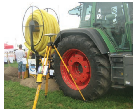
9. kép. Marótárcsás dréncsőfektető berendezés
