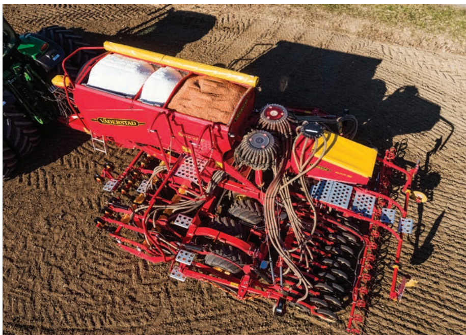
Az InLine eljárás során alacsony dózisu műtrágyát juttathatunk ki a vetőcsoroszlyákon keresztül a magárokba
