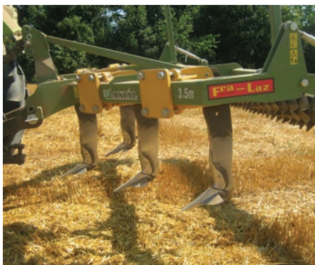
3. kép. Korszerű mélylazító-konstrukció és a vakonddrénes megoldás
