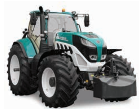
4. kép. ARBOS 7260 típusjelzésű, 280 lóerős, univerzális, négykerék-hajtású traktor (forrás: www.arbos.com/products )
