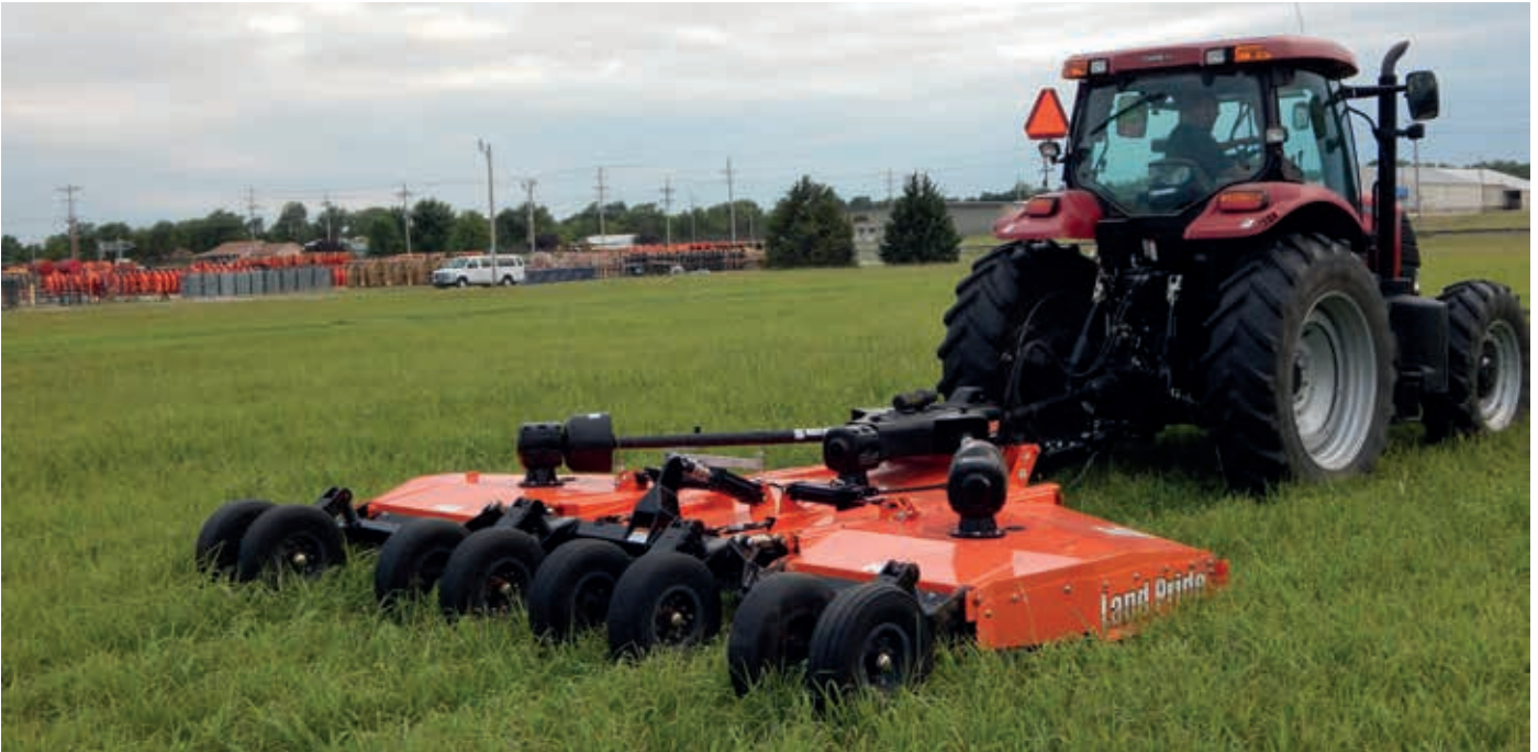
Három vertikális rotoros, lengőkéses, vontatott szárzúzó
