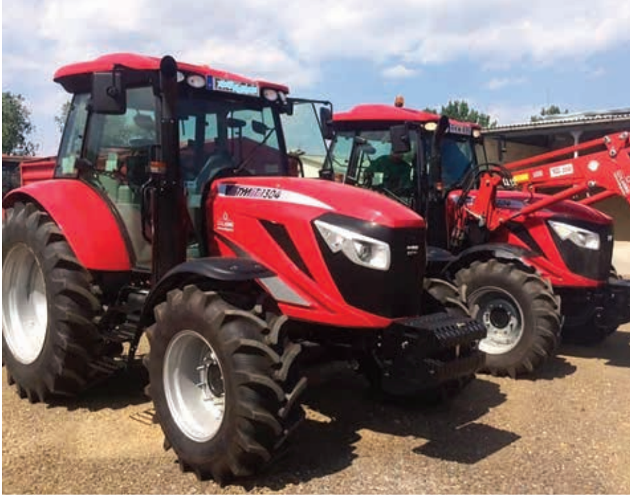
3. kép. TYM T1304 típusjelzésű, 130 lóerős, univerzális, négykerék-hajtású traktor (forrás: https://gazdaktere.hu )
