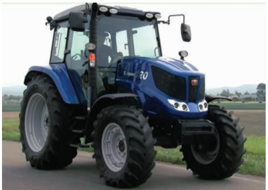
2. kép. ISEKI TJW120 típusjelzésű, 120 lóerős, univerzális, négykerék-hajtású traktor (forrás: https://youtube/y2BZaTRZ3b8?t=0 )
