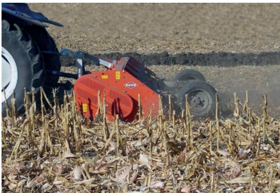
A hajtott szártépők munkáját nem befolyásolja a szárok nedvességtartalma
