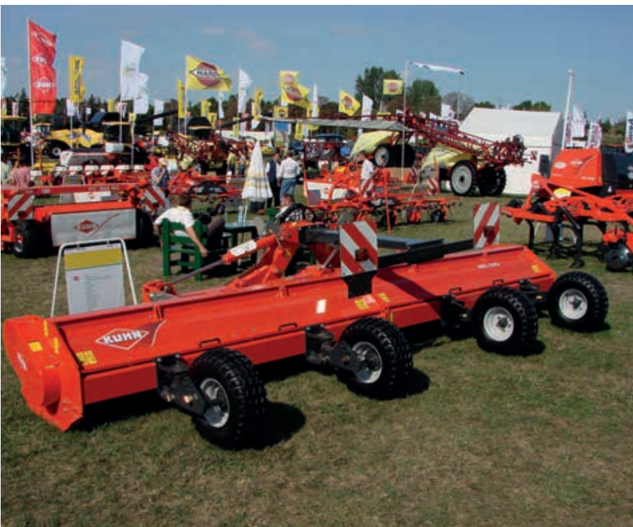
Osztott vázszerkezetű, hidraulikusan összecusukható, 6 méteres, vízszintes tengelyű zúzó
