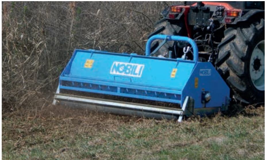
A kalapácsos rendszerű vízszintes tengelyű mulcsozók bozótok és egyéb vastag, fás szárú bokrok hatékony irtására is jól alkalmazhatók
