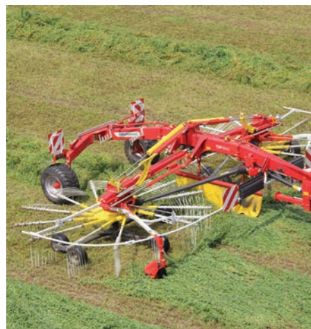
A vertikális rotorok lehető legjobb talajkövetése érdekében a gyártók egyre több fejlesztést alkalmaznak
