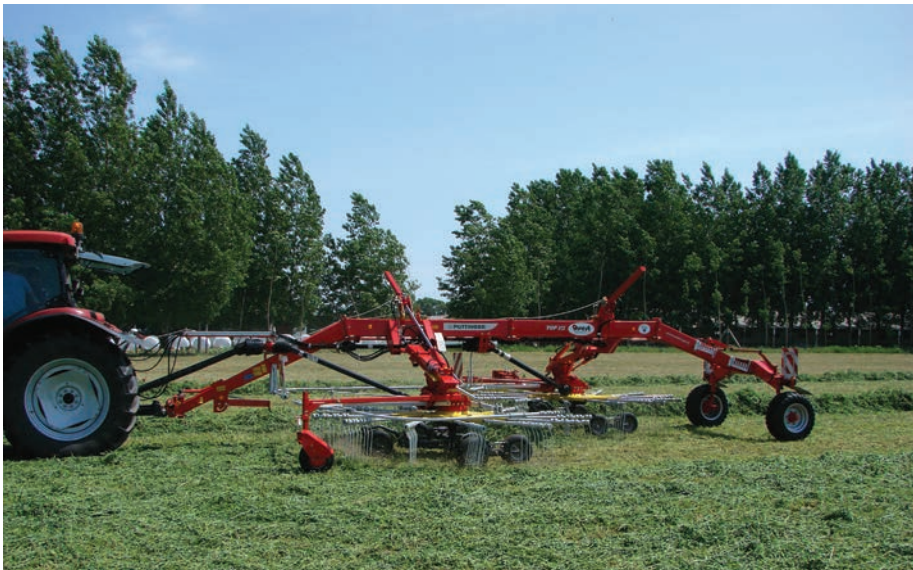
Az oldalra dolgozó, vertikális rotoros rendképzők munkaszélessége jól igazítható a hozamhoz
