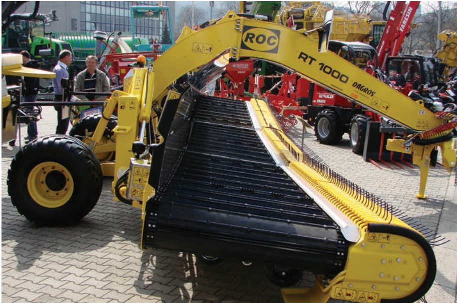
A rendfelszedő dobos, hevederes rendképzők legnagyobb előnye a rendelhelyezés variálhatósága
