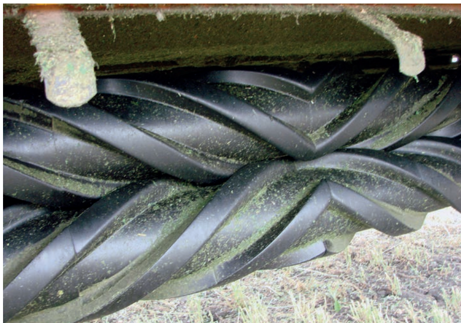
Mérjük meg a szársértő bordás gumihengerek távolságát, amely nem lehet több mint 2 mm
