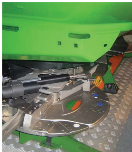
1. kép. A röpitőtárcsás műtrágyaszóró gépekre a tökéletes, változtatható számú és lapátozású szórószerveket a jellemző
