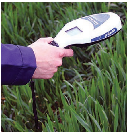
7/a-b kép. A fejtrágyázás során a GreenSeeker szenzortechnológia kézi és gépi változatai is jól használhatók
