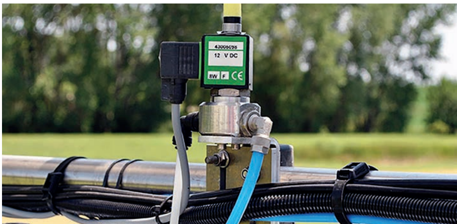
7. kép. Az ActivAir vezérlőrendszer egyik mágnesszelepe ( http://www.hardi-international.com )
