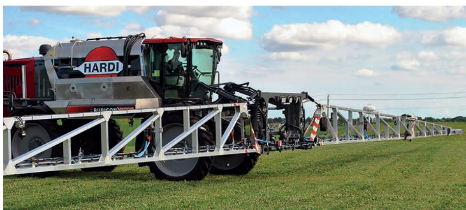
1. kép. HARDI RUBICON 9000 önjáró permetezőgép szétnyitott szórókerettel (forrás: https://maxwellfarmsservice.ca/Hardi/ )
