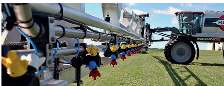
6. kép. A cseppegésmentes fúvókák elhelyezése a szórókereten ( https://maxwellfarmsservice.ca/Hardi/ )
