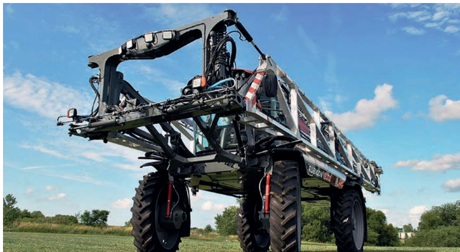
2. kép. A permetezőgép behajtott szórókerettel ( https://maxwellfarmsservice.ca/Hardi/ )
