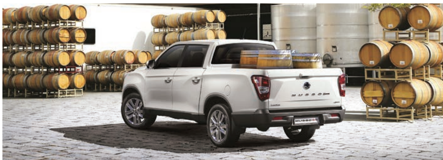
A hosszított karosszériájú Musso Grand pick-up tengelytávja 3210 mm, hossza 5405 mm, teherbírása laprugós hátsó felfüggesztés esetén 1062 kg
