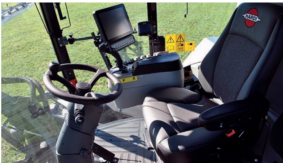
5. kép. A RUBICON 9000 permetezőgép kezelőszerveinek elhelyezése ( https://maxwellfarmsservice.ca/Hardi/ )
