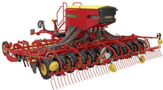
Rapid A 600S vetőgép tárcsás magágykészítő-egységgel, E-control vezérléssel
