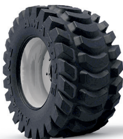
Matrix-kerekek 40 km/h sebesség közúton, és sávos visszatömörítés
