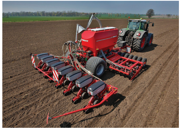
Pronto 6 AS PPF és Maestro 8 RC: a vetőmag mellett kétféle műtrágya, valamint mikrogranulátum kijuttatása egy menetben
