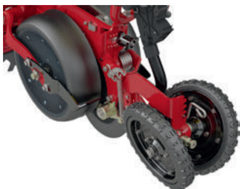
Repce és cukorrépa vetéséhez opcionális aprómag vető készlet rendelhető
