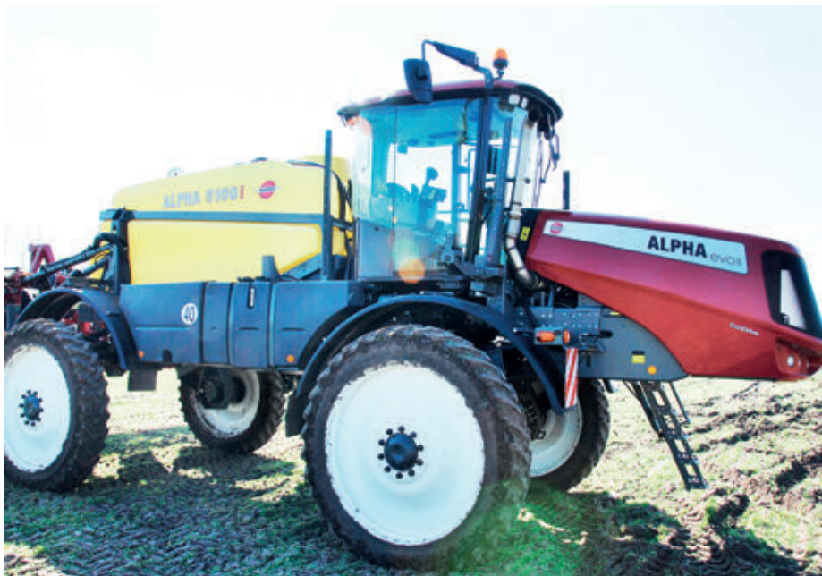
A hidraulikus nyomtávállítási funkció 180-230 cm közötti tartományban állítható
