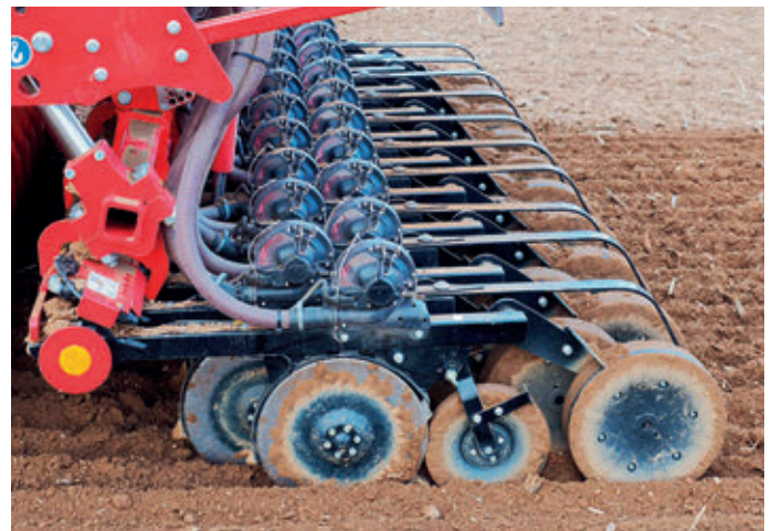
Szemenkénti adagoló a turbodisc vetőcsoroszyán
