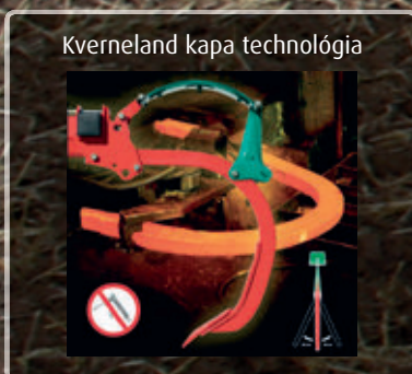
Auto-reset vagy nyírócsapos kapabiztosítás
