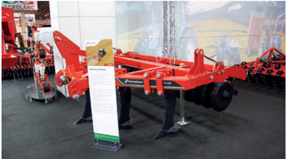
Kverneland Flatliner lazító, 3 és 5 késes változatban
