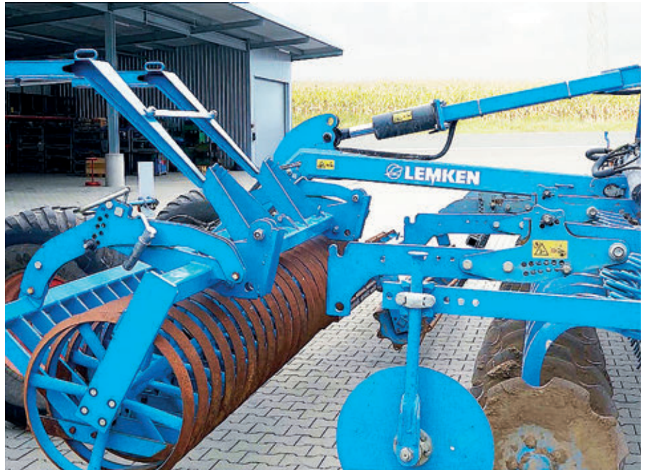
A nyitható kampókkal a hengerek rakodóvillával könnyen szállíthatók
