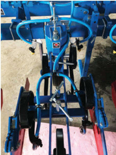
IZIFLO sávpermetezővel és injektálókapaival szerelt művelőkocsi
