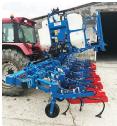
ECONET sorközművelő sávpermetező és injektáló rendszeres IZIFLO-val
