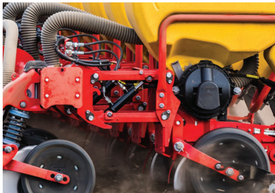
A hidraulikus súlyráterhelés a Tempo-hoz választható opció
