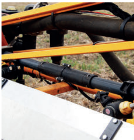
A mágneses rendszer három egyszerű összetevőből áll: az elsődleges mágnes dobozokból, valamint a gerinccsőre és a szórófejekre szerelt jelerősítő mágnesekből
