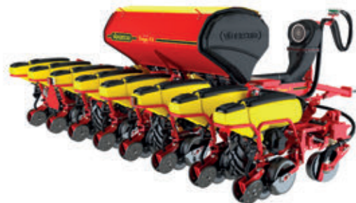
Tempo F8 vontatott vetőgép, 75 cm-es sortávolsággal, 1 800 literes műtrágyatartállyal
