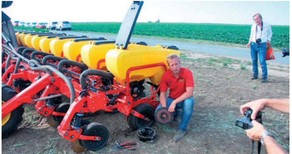
A Tempo „lelke” az egyedi Gilstring magadagoló egység, amely a nagy vetési sebesség esetén is kimagasló precizitást biztosít
