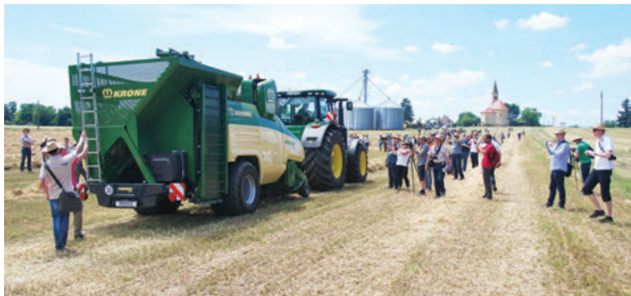
Itt debütált a Premos 5000: az első olyan munkaeszköz, amelyik egy menetben képes pellet előállítására, közvetlenül a szántóföldön
