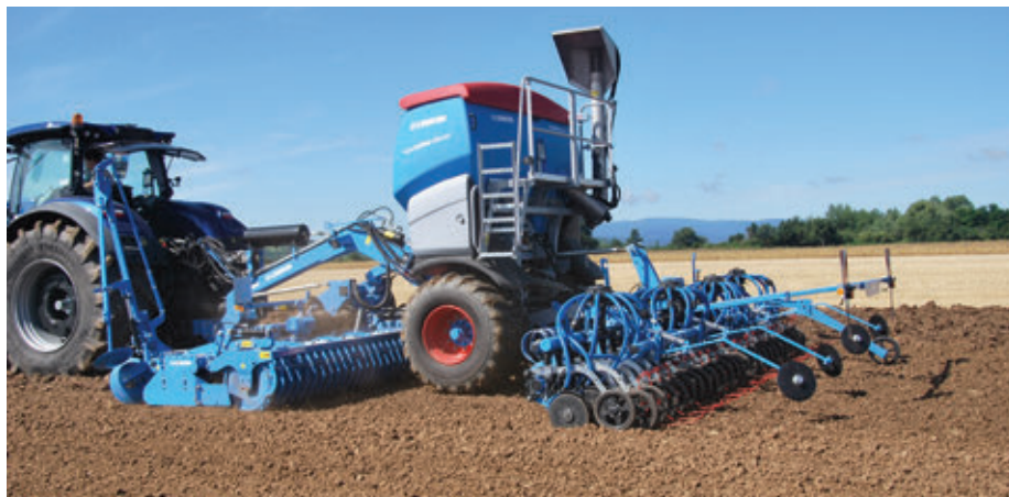
Az átdolgozott Solitair 25 3000 liter kapacitású tartállyal
