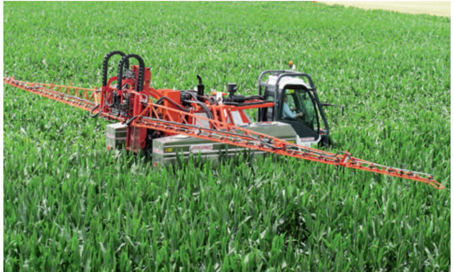
Az URAGANO önjáró permetezőgépek fő előnye a nagy szabad hasmagasság (263 cm) és a fokozatmentes hidraulikus nyomtávállítás
