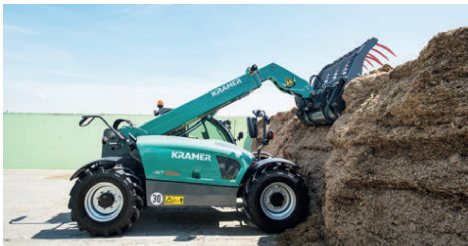
Kényelmesnek és stabilnak tartjuk a munkaeszközök négy pontos felcsatolását
