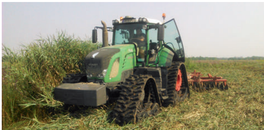
A Soucy Track használatával a kerékcúszás (szlip) mértéke szinte nullára redukálható
