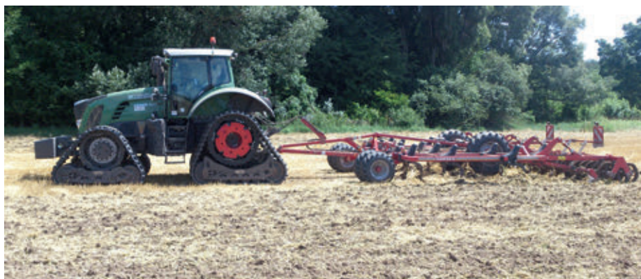
Ugyanaz az erőgép Soucy Trac-rendszerrel felszerelve mintegy 30%-kal nagyobb vonóerő kifejtésére képes
