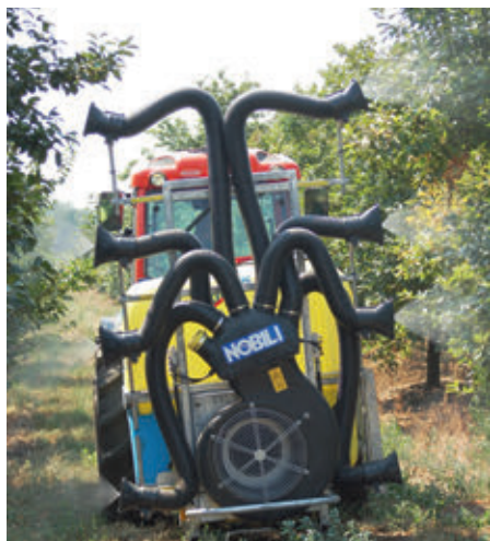
Az elektrosztatikus Oktopus permetezőgéppel mintegy 60% növényvédő szer takarítható meg
