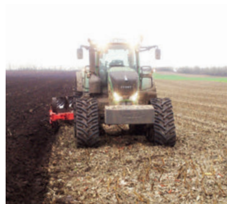
Az erőgép szélessége nem haladja meg a 3 m-t, így nem okoz gondot a közúton való közlekedés
