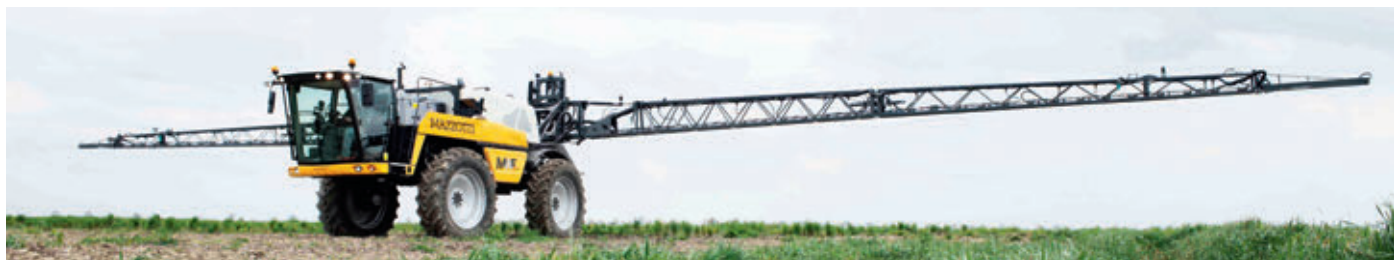
A szórókeretek különböző kivitelben elérhetőek 24-től 48 m szélességig: festett acél, rozsdamentes acél, karbonszálas, légszásos változatban
