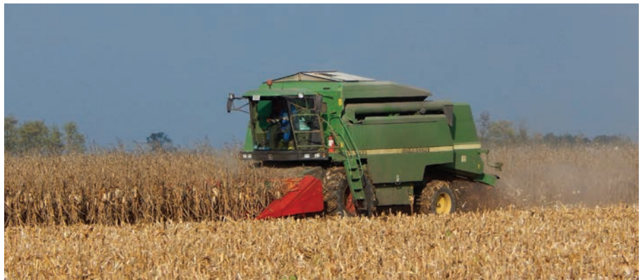
A szárzúzott, de magasra hagyott kukoricatarló is rövidítheti a betakarítógép abroncsainak élettartamát
