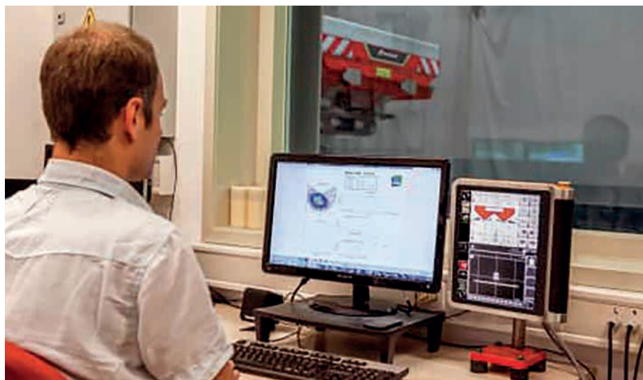
2. kép. A gyártási folyamat után a gyártók „TESZT” laborokban mérik be a beállítási paramétereket
