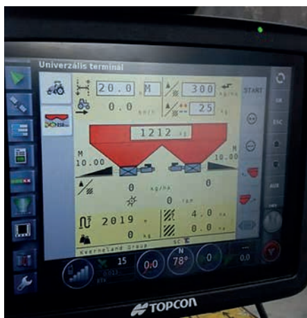
7. kép. A szenzortechnológia, ISO-BUS adatátvitel, és terminál segítheti a gépkezelő munkáját
