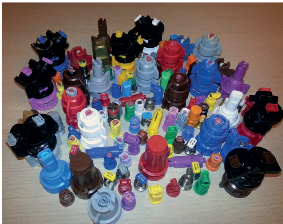
6. kép. A műszaki vizsgálatnál a szórókeretekre illesztett szórófejeknek ugyanolyan típusúnak, méretűnek és anyagúnak kell lenniük
