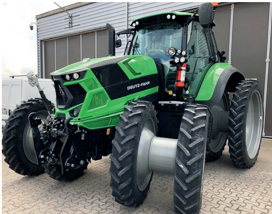
2. kép. Ikerkerekes művelőkerék-abroncsozás (forrás: www.fandav.hu)
