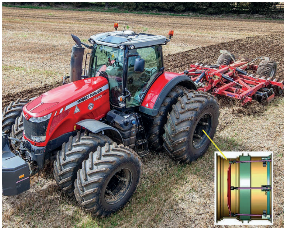
1. kép. Ikerkerekés dupla standard abroncsozás, csatos stock ikerfelnivel (forrás: https://www.stocks-ag.co.uk/media-gallery )
