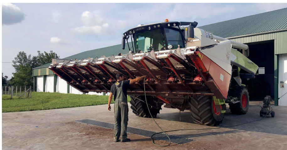
A sűrített levegővel való tisztítás
