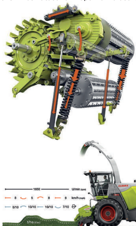
1/a-b ábra. A behordó szerkezet tömörítő mechanizmusa, és az automata terhelésszabályozás elve
