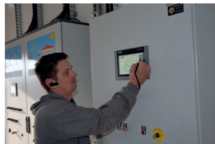
Az automata PLC vezérlésnek köszönhetően egyszerű a technológiai sor kezelése, mutatta be a berendezés működését Vass László családi gazdálkodó
