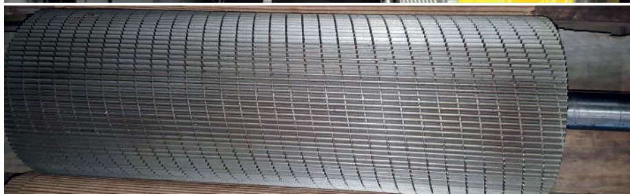
6/a-b kép. A John Deere 800-900 sorozat kiiktatható foszlató szemroppantó hengerpárja, és spirális rovátkolt szemroppantó hengere
