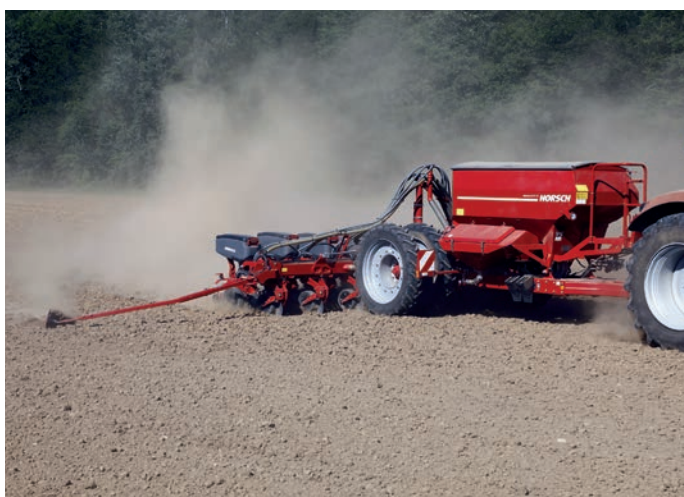
Maestro CV Ikerkerekek nagyméretű gummiabroncsokkal
