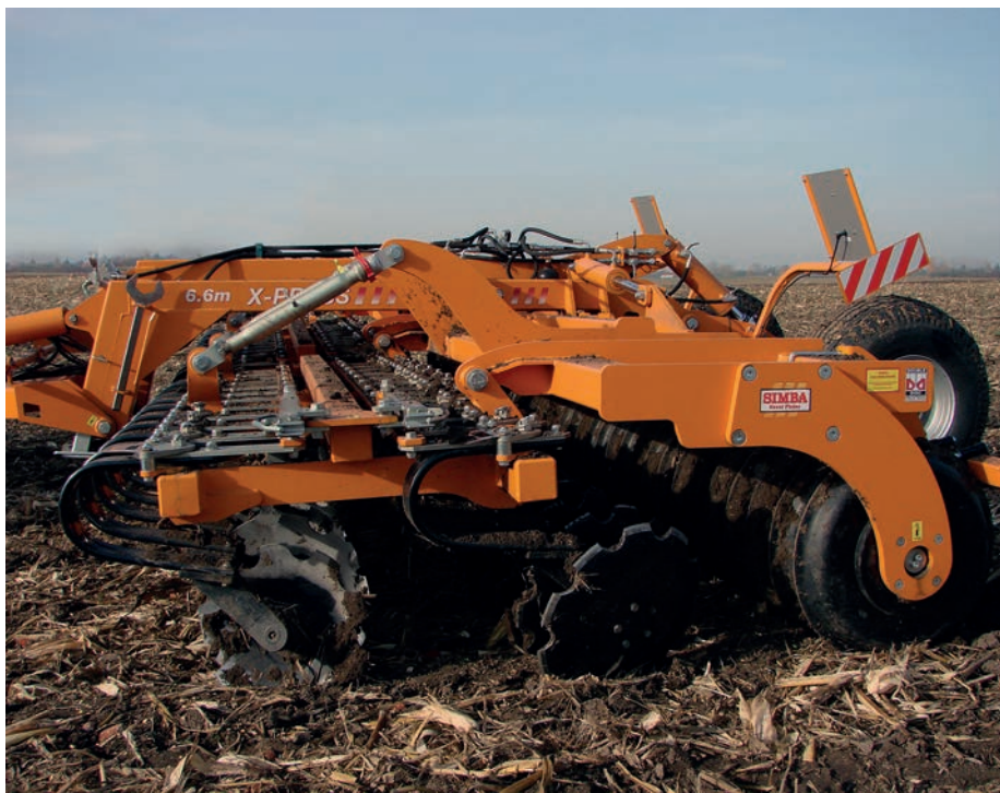
4. kép. Laprugós tárcsatag felfüggesztésű, állítható szögállású rövidtárcsa
