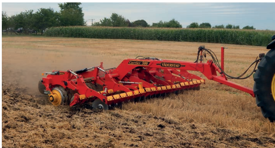
2. kép. A kúpos tárcsalapokkal szerelt típusok a nyári tarlóhántás mellett, tavaszi szántáselmunkálásra, és ultrasekély művelésre is kiválóan alkalmazhatók
