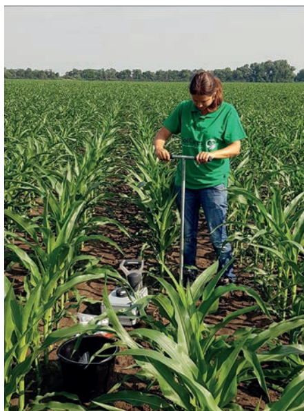
Mintavétel talajfűróval és azonnali, helyszíni talajvizsgálat hordozható spektroszkóppal
