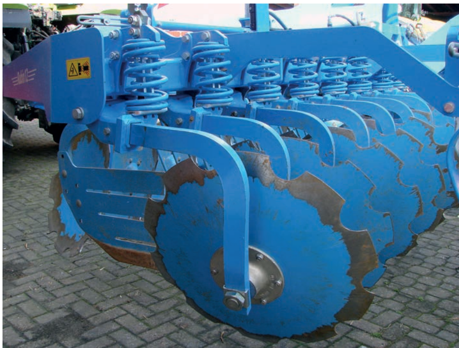
3. kép. Spirálrugós túlterhelés biztosítású felfüggesztéssel szerelt tárcsatag
