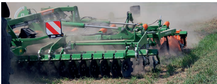
A Ceus ötvözi a kompakt tárca sekély művelési mélységnél nyújtott előnyeit egy kapamezővel a mély talajlazításhoz
