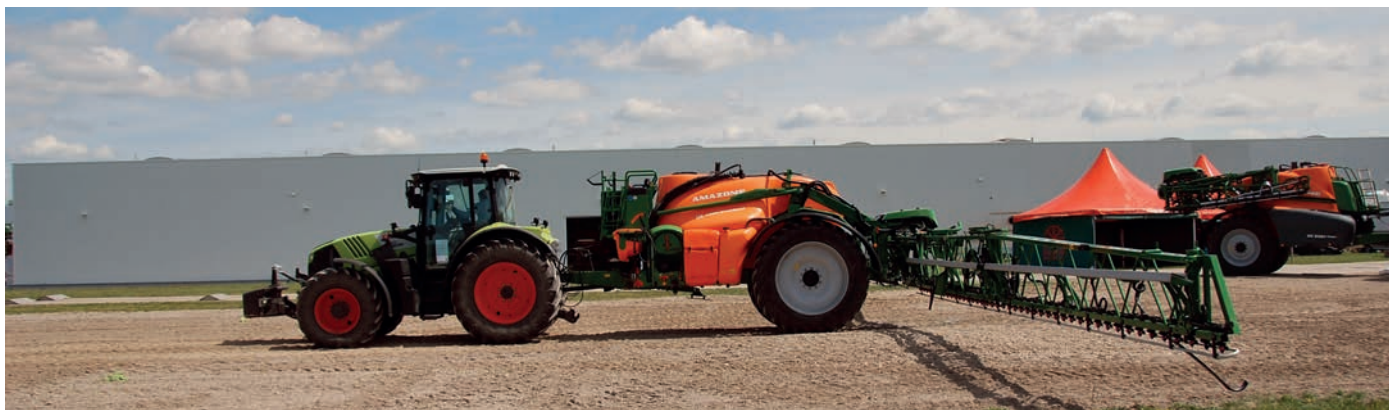
Az UX-tartály kialakítása és az AMAZONE szórókeret alacsony súlypontot és nagyon kompakt szállítási méreteket biztosít
