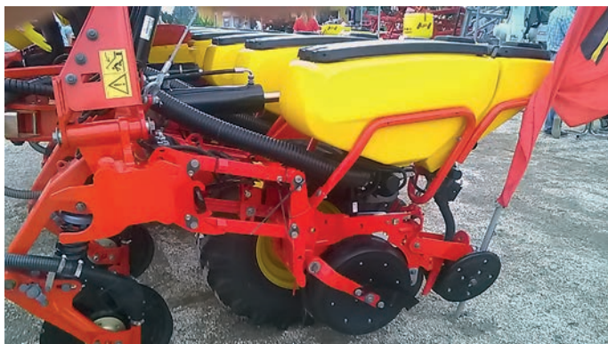
2. kép: A Väderstad Tempo szemenként vető gépek vetőkocsijainak csoroszlya terhelése hidraulikusan 350 kg-ig növelhető
