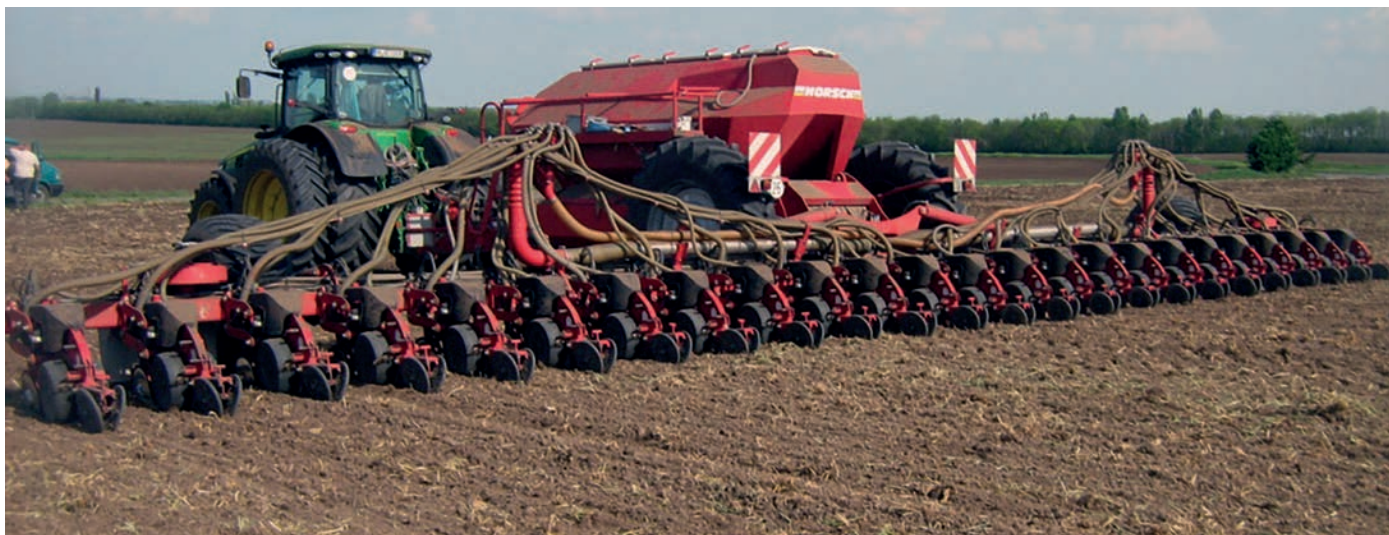
7. kép: A területteljesítmény növelése miatt nem ritka a szemenként vető gépeknél a 24 soros változat
