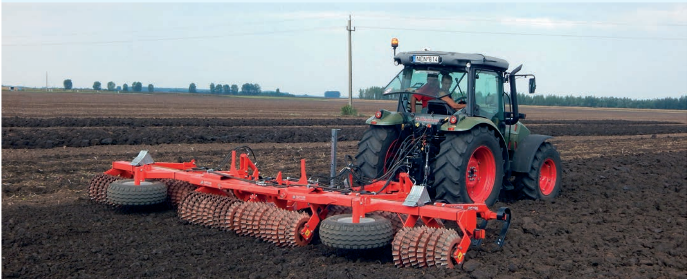
A prizmaprofilú hengerek esetében még nedves talajkörülmények között is jó a rögtörés tömörítés hatásfoka
