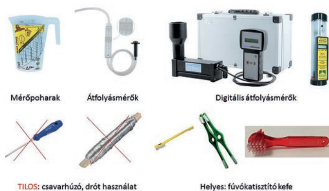
1. ábra: Fúvókaadagolási teljesítménymérők, ajánlott, illetve nem ajánlott tisztító eszközök
