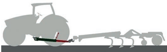
1. ábra: Fendt VarioPull munkagépkapcsolás vázlat (forrás: www.fendt.com)
