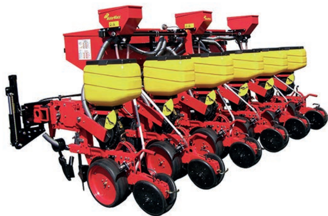
6. kép: A kompakt kialakítású MaterMacc szemenként vető gép
