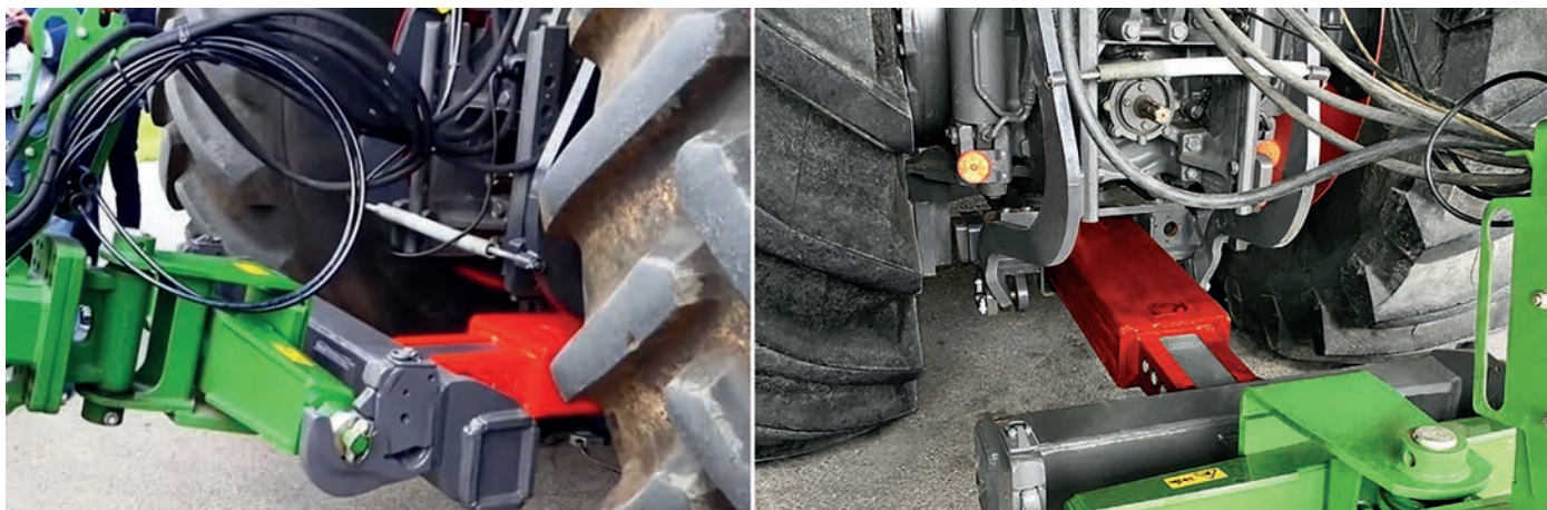
2. kép: Fendt VarioPull traktor-munkagépkapcsolási megoldás bal- és jobboldali képe (forrás: www.fendt.com)
