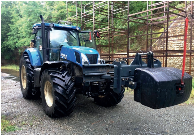
3. kép: A pótsúly távolságának folyamatos változtatására szolgáló berendezés (forrás: www.eima.it/en/index.php )
