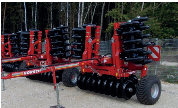
A mélytömörítő hengerek leginkább a talajlazítók, nehéz-kultivátorok kiegészítő művelőeszközei, de önálló munkagépként is elérhetők
