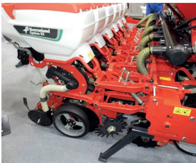
9. kép: A sortisztítóval szerelt vetőkocsik szármaradványos területen is biztonságos vetést végeznek
