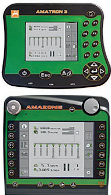
5. kép: A szemenként vető gépek folyamatai ISOBUS terminállal vezérelhetőek és ellenőrizhetőek
