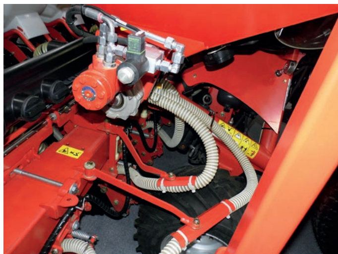
3. kép: A szemenként vető gépeknél a mechanikus hajtásátvitel mellett a hidrosztatikus- és elektromos hajtás is terjed
