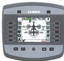
3/a-b. ábra Független tengelyű rotoros és rendfelszedős, szalagos rendezelő gépek üzemállapotát jelző terminálok
