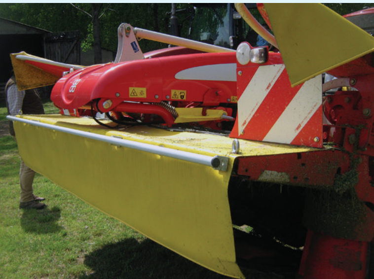
1. ábra Mellső függesztésű rotációs kaszák függesztő mechanizmusa
