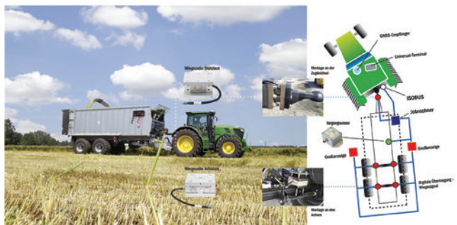
11. ábra Az elektrotenzometrikus tengelymérés, a szenzortechnológia és a GPS-alkalmazás kombinációja pótkocsinál
