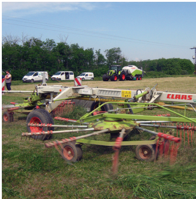
4. ábra Vezérelt ujjas rendrakók talajkövető futóműve
