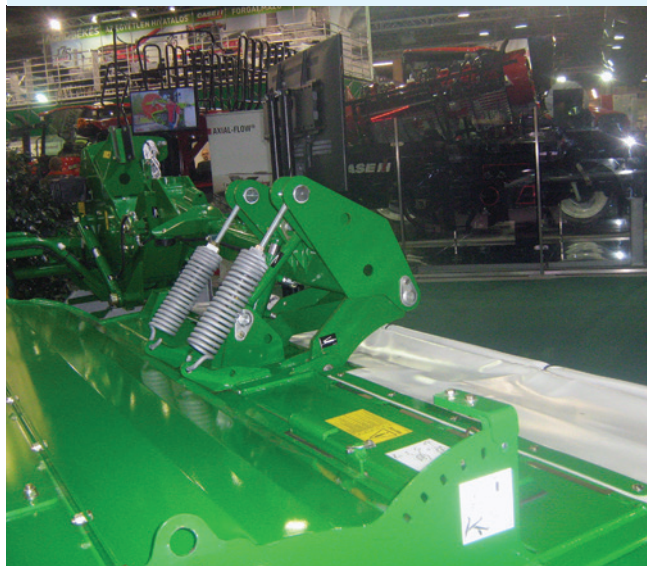
2. ábra Újdonság a súlyponti megfogás és a paralelogramma függesztés kombinációja
