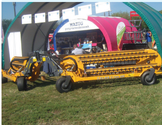
5. ábra Dobos rendsodró konstrukció
