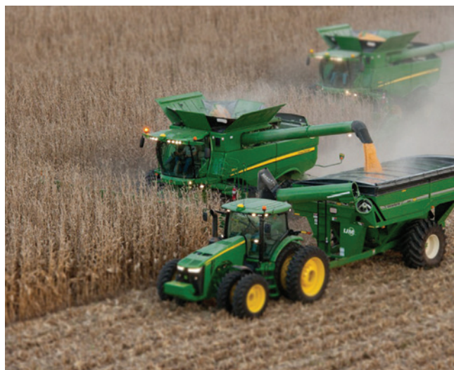
8. ábra A GPS automatakörmányzás és terhelésvezérlés a járműszinkronizálást is megvalósíthatja
