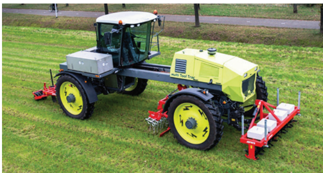
3. ábra. „Multi Tool Trac” elnevezésű négy kerékajtású, négy kerékkormányzású, univerzális hibridhajtású traktor (Forrás: www.multitooltrac.nl )
