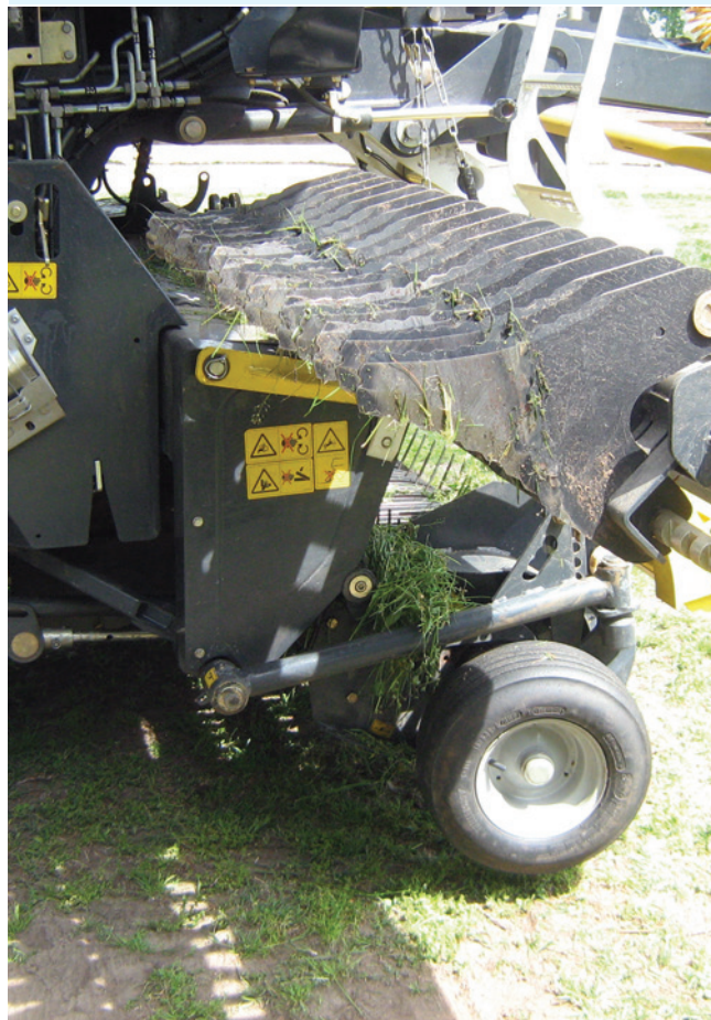
7. ábra Változókamrás, hevederes, hengeres bálázó szeletelő berendezéssel
