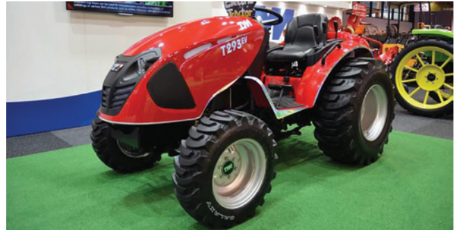
11. ábra. TYM T293EV típusjelzésű dél koreai tiszta villamos hajtású traktor (Forrás: https://www.profi.co.uk/steven-vale )
