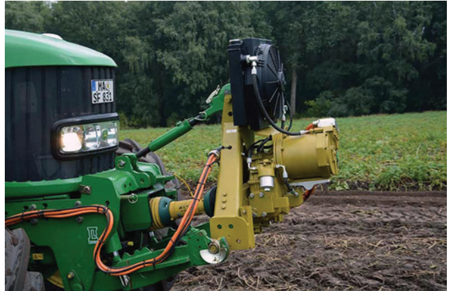
1. ábra. GKN Walterscheid „ePower-Generator”, villamos energiát szolgáltató egység, traktorra szerelve (Forrás: www.gkn-walterscheid.de/presse/ )
