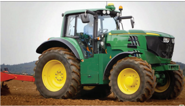
8. ábra. John Deere SESAM 300 kW-os „Plug and Play” elektromos traktor (Forrás: www.profi.com )
