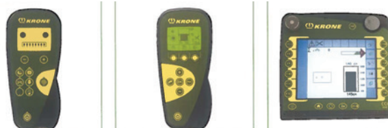
4. ábra Hengeres bálázók szenzoros vezérlői és ISOBUS-terminálja
