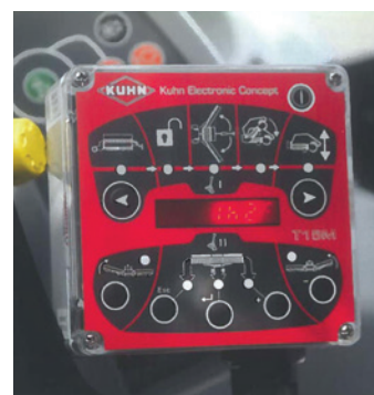
3/a-b. ábra Független tengelyű rotoros és rendfelszedős, szalagos rendezelő gépek üzemállapotát jelző terminálok
