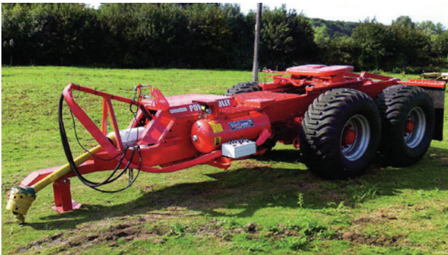
10. ábra. Hajtott kerekű, kéttengelyes „Power Dolly” (Forrás: www.byeengineering.co.uk )
