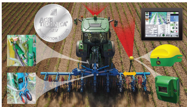
John Deere AutoTrac Implement Guidance automatikus kultivátorvezérléssel
