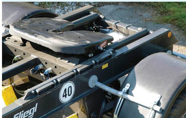
9. ábra. Hidraulikusan hosszirányba állítható dolly nyeregszerkezet (Forrás: www.fliegl-agrartechnik.de )
