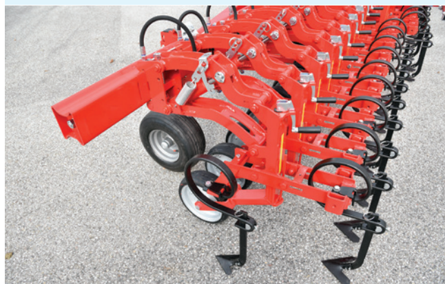
Einböck Chopstar sorközművelő művelőtagonkénti GPS-vezérléssel
