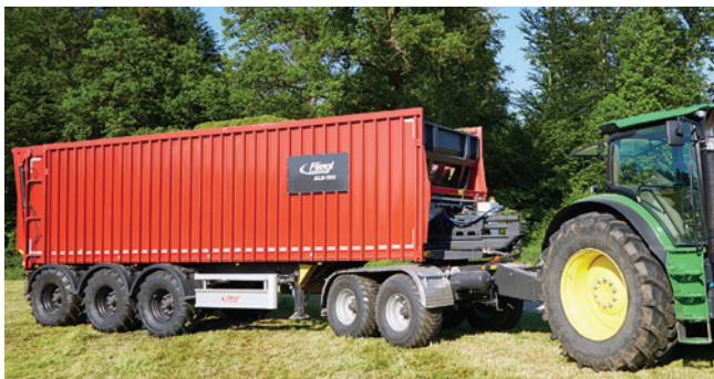
4. ábra. Traktorvontatású Fliegl ALU-TEC letoló rendszerű nyerges félpótkocsi (Forrás: www.fliegl.hu/assets/mezo-gazd_szallito.pdf )
