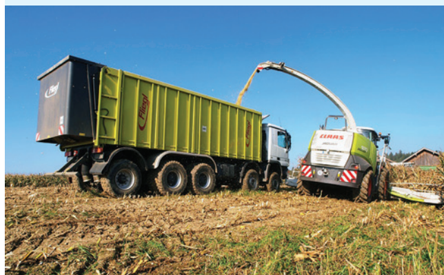
3. ábra. Nyergesvontató Fliegl ASW típusjelzésű letolós félpótkocsival (Forrás: www.fliegl-agrartechnik.de )
