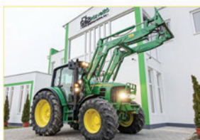
John Deere 6430 PRÉMIUM ÜZEMÓRA: 4270 24/24 PowerQuad 40 km/h, TLS, 3 SCV, légrugós ülés, homlokrakodó
