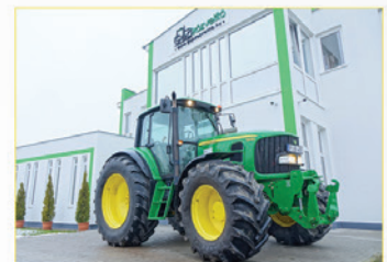
John Deere 6830 ÜZEMÓRA: 4620 20/20 PowerQuad 40 km/h, TLS, 3 SCV, légrugós ülés, fronthidraulika
