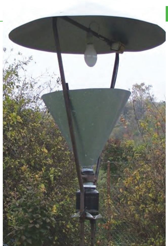
6. ábra Jermi típusú fénycsapda. Fotó: Takács Attila
