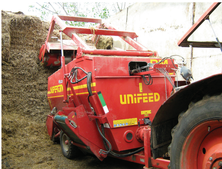
2. ábra Vízszintes csigás kocsis feltöltése saját silómaróval
