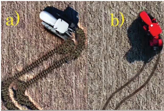
6. ábra A talaj igénybevételének összehasonlítása a) gumihevederes és b) kerék-gumihevederes járószerkezet esetén (Forrás: www.caseih.com)
