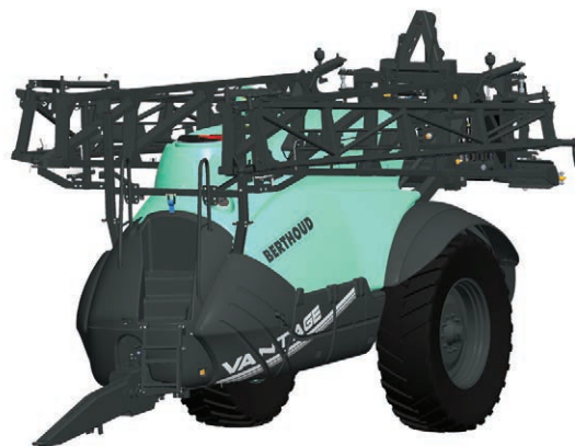
8. ábra: A VANTAGE vontatott sorozat legnagyobb, 6.700 literes gépe
