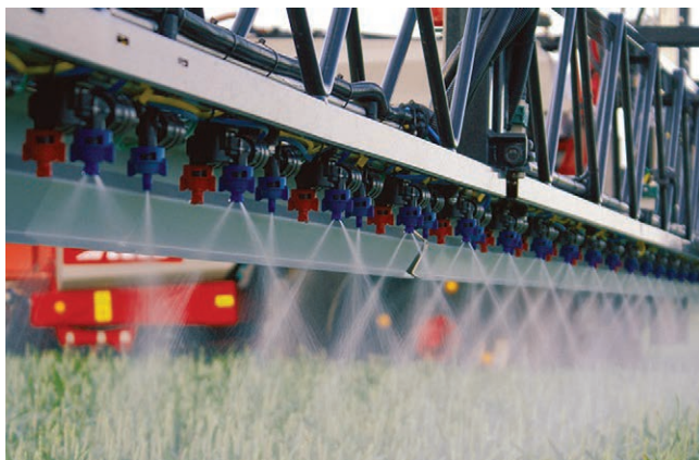
2. ábra: A megfelelő fúvókátávolságú keskenysugarú szórás
