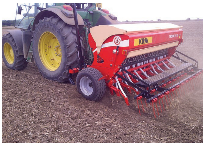
KRM (Sola) Trisem-2110 hagyományos építésű, mechanikus vetőszerkezetű, csúszó csoroszlyás gabonavető gép
