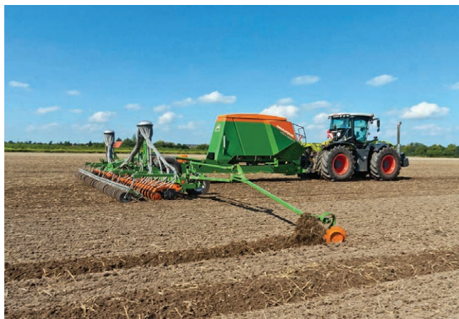
Vontatott vetőkocsis, hagyományos építésű, pneumatikus vetőszerkezetű nagyteljesítményű gabonavető gép (Amazone Citan 12001)
