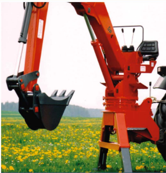
9. ábra. Ostler DP-5 típusjelzésű, traktorra szerelhető 5 m emelő magasságú, 5 m kinyúlású, 900-1430 kg emelő képességű hidraulikus forgórakodó (Forrás: www.ostler-maschinen.de )
