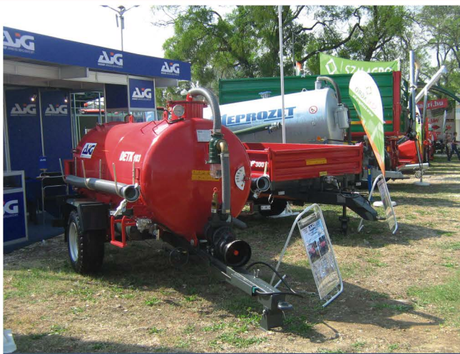
8. kép A kisebb tartálytérfogat melletti légszivattyús feltöltő rendszer
