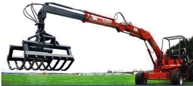
10. ábra. Ostler FL700 típusjelzésű, vontatott univerzális hidraulikus forgórakodó, teleszkópos gémmel, 6,8 m emelő magassággal, 5,8 m kinyúlással, 1700-3800 kg emelő képességgel rendelkezik (Forrás: www.ostler-maschinen.de )
