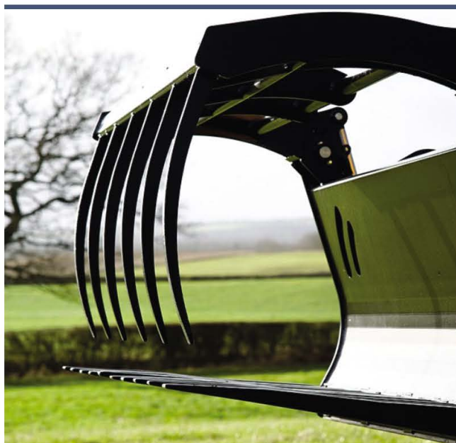
6. ábra. Silózási munkákhoz alkalmas vágókéses munkaeszköz (Forrás: www.alo.se)
