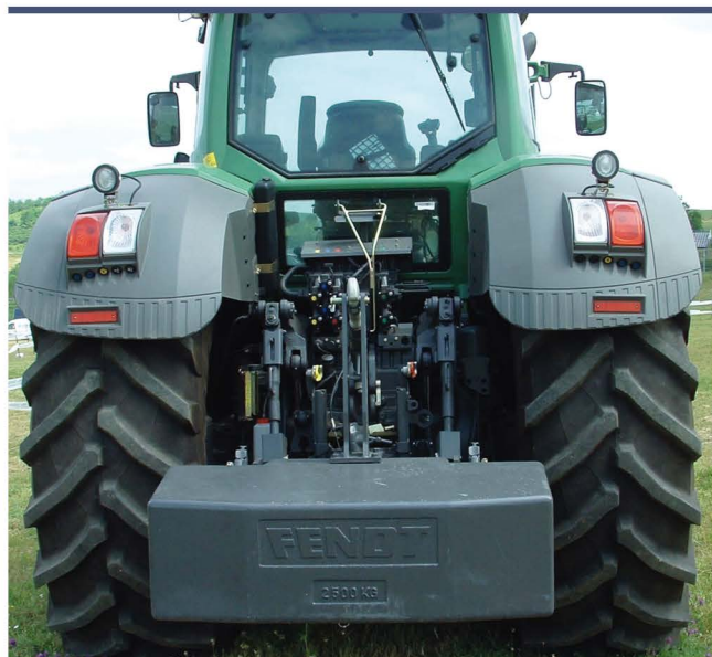
8. ábra. Homlokrakodó alkalmazása esetén a traktor hátsó függesztő szerkezetén elhelyezett tömsúly
