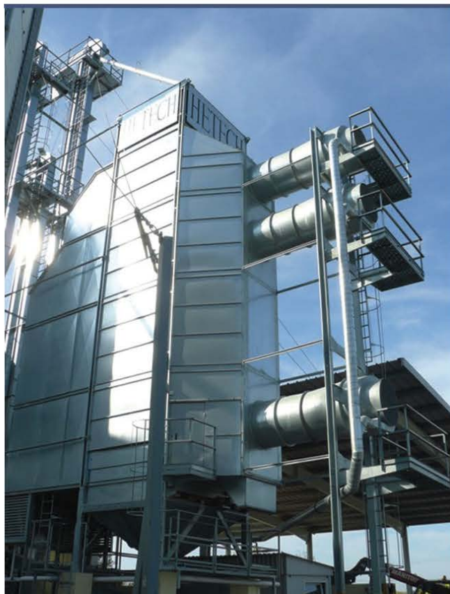
4. ábra Hetech szárító torony (pontszerű légszennyező forrás, centrifugál leválasztó, szekvenciális légtechnikai rendszer szabályozás)
