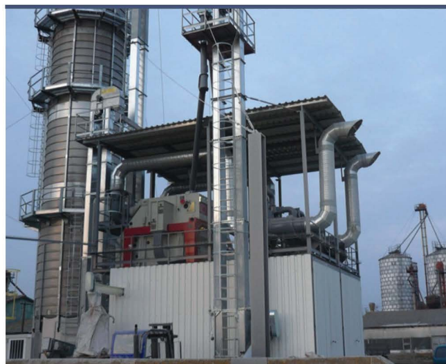
2. ábra: HEVESGÉP szárítótelep (HEVES-X gyűrűaknás szárító, TAS 145 magtisztító, HC centrifugál leválasztó
