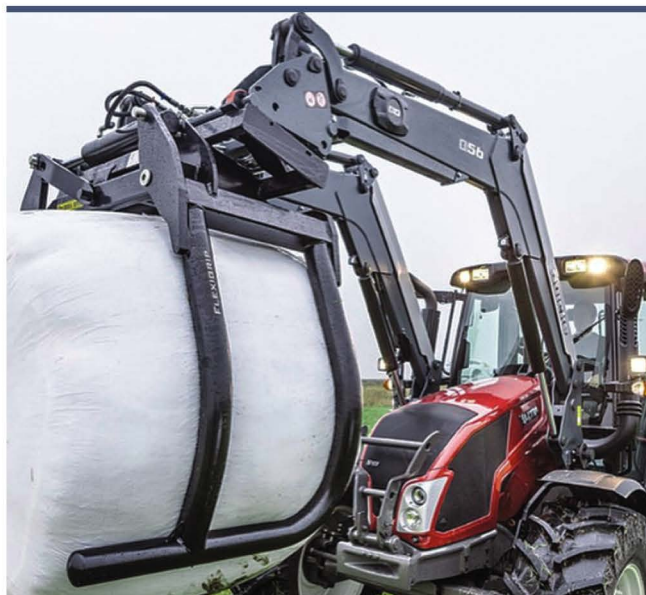
7. ábra. Csomagolt bálák mozgatásához alkalmas eszköz (Forrás: www.alo.se)
