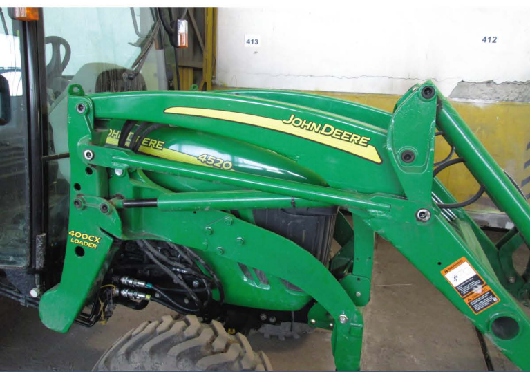
2. ábra. John Deere 400 CX típusú mechanikus párhuzamvezérlésű homlokrakodó a JD 4520 típusú traktorra szerelve (Forrás: www.deere.com )
