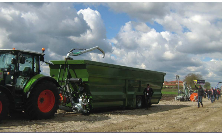
3. kép Telepíthető, mobil hígtrágyakonténer kiépített töltő- és ürítoszivattyú csőcsonk rendszerrel
