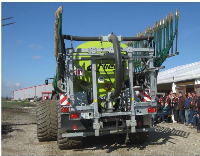
9. kép Nyomtávnövelés a területen történő mozgáskor javítja a vontatási jellemzőket, csökkenti a taposási kárt
