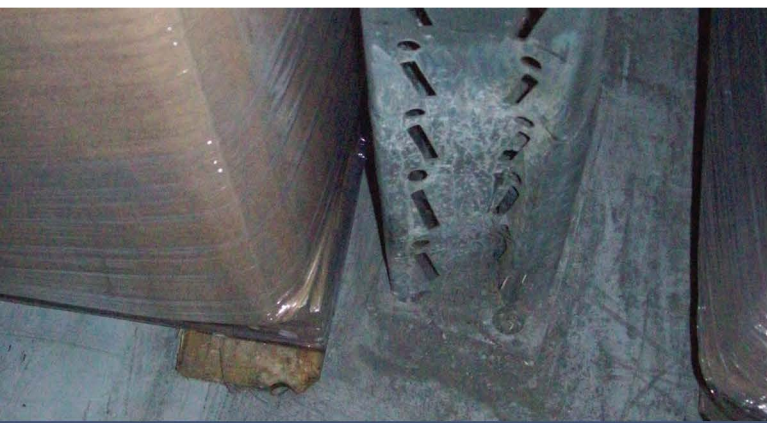
1. kép: Toló-oszlopos targonca által okozott sérülés
