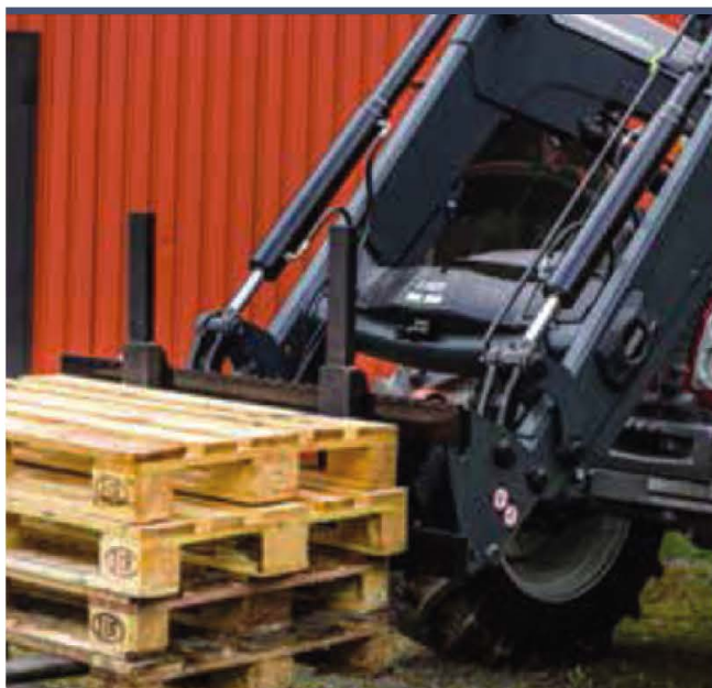
5. ábra. Rakodólap mozgatása villás munkaeszkővel (Forrás: www.alo.se)
