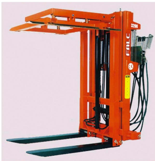
11. ábra. Falc Triplex 3800 típusjelzésű traktorra szerelhető hidraulikus villás emelő 1500 kg terhet képes 3,8 m magasra emelni (Forrás: www.falc1960.com )
