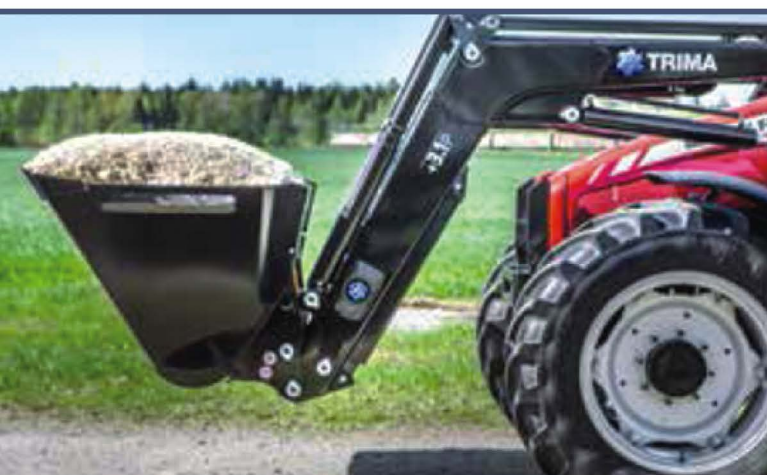
3. ábra. Kanalas munkaeszköz kis térfogattömegű anyagok rakodásához (Forrás: www.alo.se )
