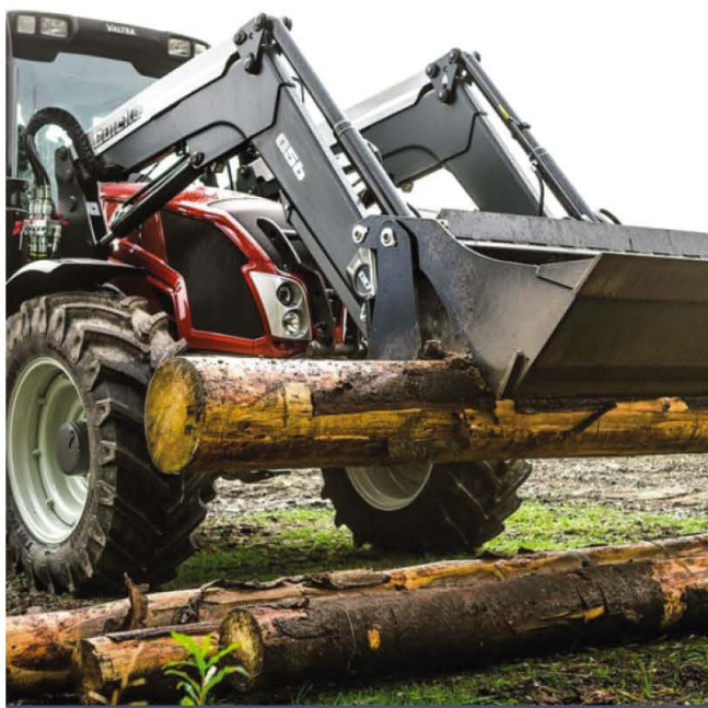
4. ábra. Ömlesztett anyagok és megfogást igénylő faronkok rakodására is alkalmas eszköz (Forrás: www.alo.se)
