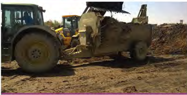
6. ábra: Gémszerkezetes, letolólapos, oldalra szóró gép baromfitrágák kiszórására kiváló
