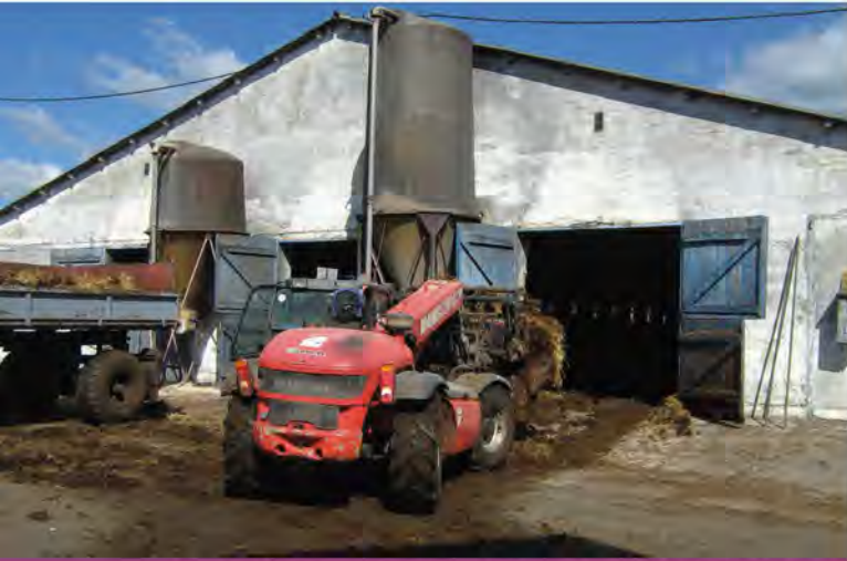
1. ábra: Mélyalmos tehénistállók kitrágyázása teleszkópos homlokrakodóval
