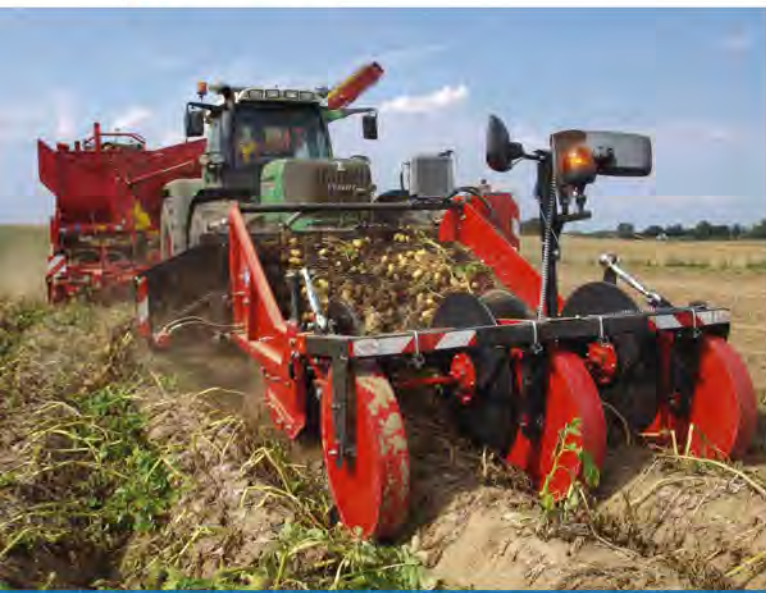
A mellső függesztésű Tolmac MT 12 adapterrel a 2 soros batakárítás 4 sorossá bővíthető
