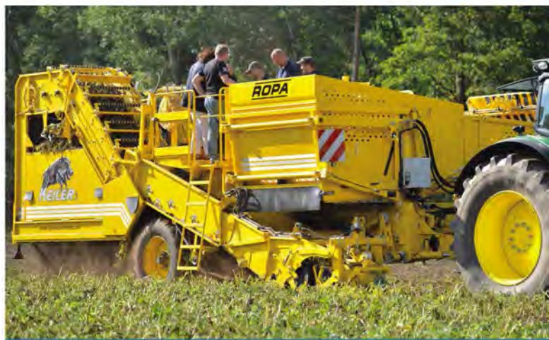
Ropa Keiler I. egymenetes, egysoros, gyűjtőtartályos betakarító gép
