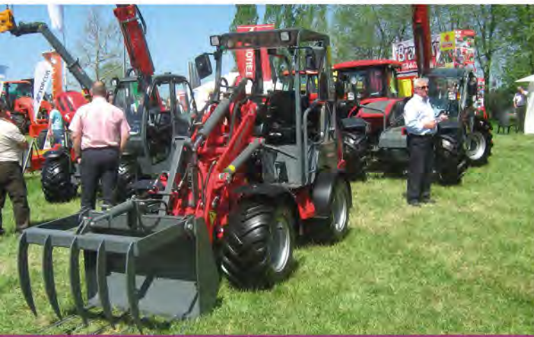
2. ábra: Baromfiistállók kitrágyázásra alkalmas kis geometriai méretű, alacsony építésű homlokrakodó gépek
