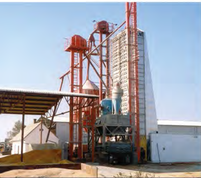
1. ábra: B1-15 szárító (nyílt diffúz légszennyező forrás)
