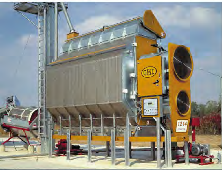
2. ábra: GSI telepi technológia, hengerrostás tisztítóval (zárt oldallemes kivitelű, diffúz légszennyező forrás)
