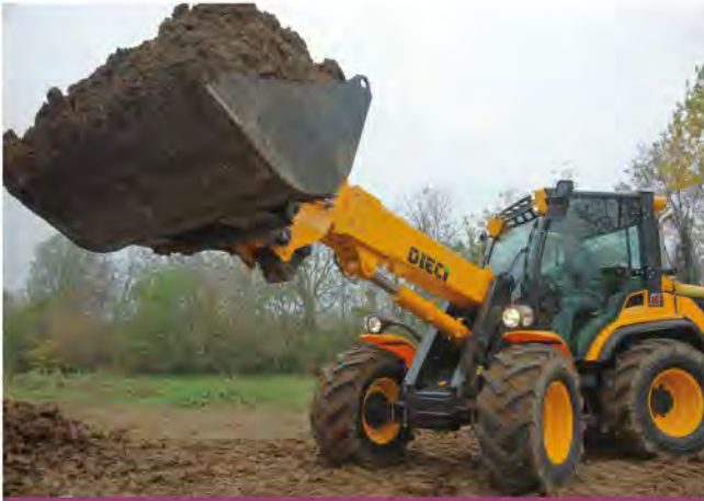
4. ábra: Gyári munkaeszközzel a rakodógépek emelőképessége kihasználható a biztonság határán belül
