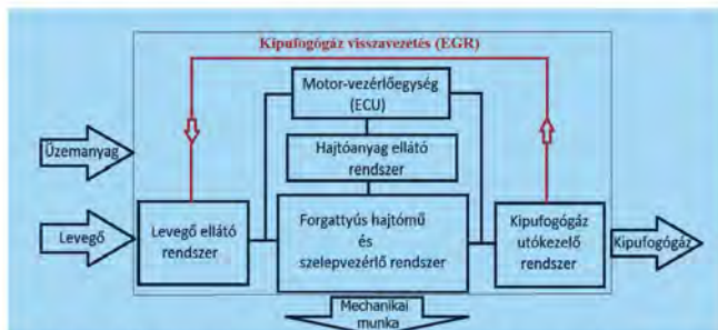
1. ábra: Dízelmotor felépítésének öt nagy alrendszere
