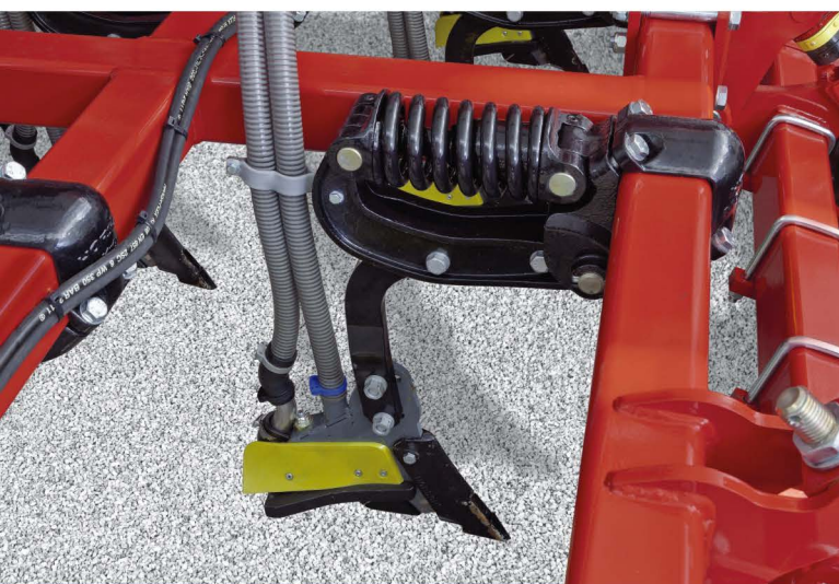
5.kép: MultiGrip késes csoroszlya vetőmag és műtrágya elkülönített kijuttatásával (Horsch Sprinter)
