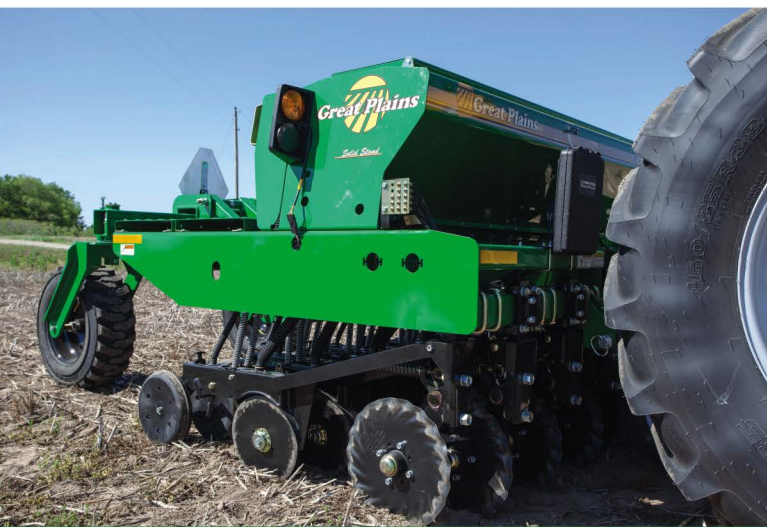
4.kép: Szárkvágó tárcsák és iker-tárcsás vetőcsoroszlyák Great Plains 3P1006NT gabona-direktvető gépen
