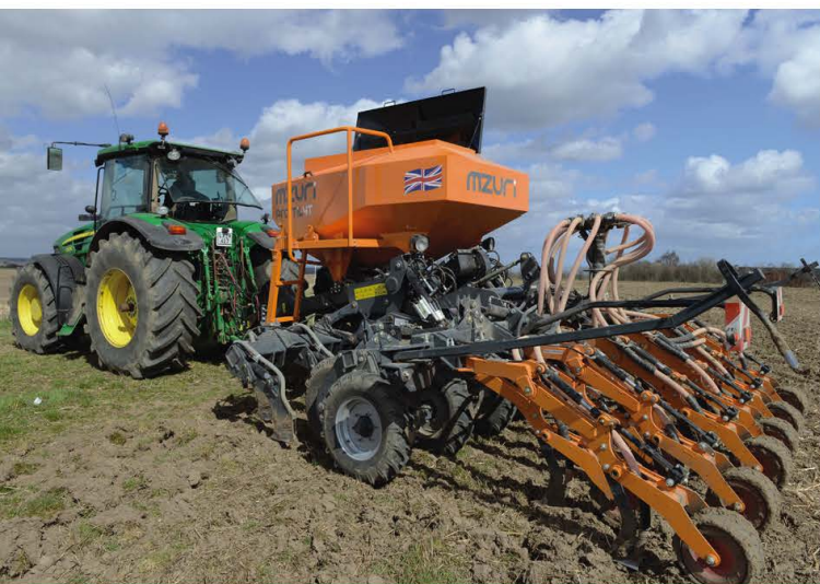
6.kép: Mzuri Pro-Till 4T (Strip Till Drill) sávművelő-gabonavető gép késes vetőcsoroszlyákkal
