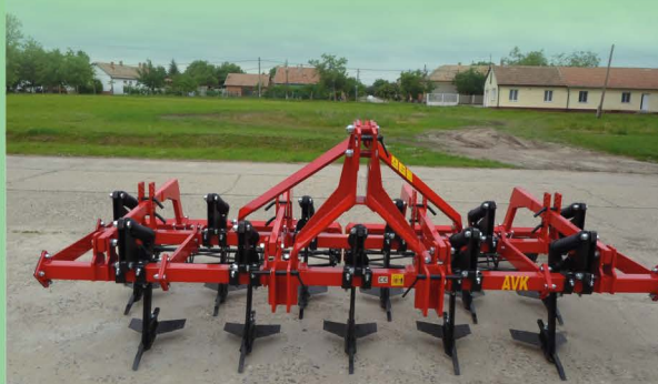
AVK ültetvény kultivátor – Munkaszélesség 1,8 2,2 2,5 3,2 4,2 m
