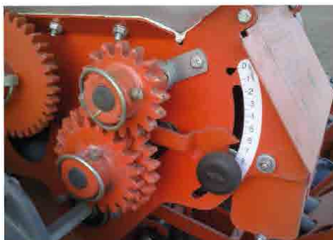
Cserélhető fogaskerekek és az adagolórés szabályozhatósága Kuhn Maxima vetőgépen
