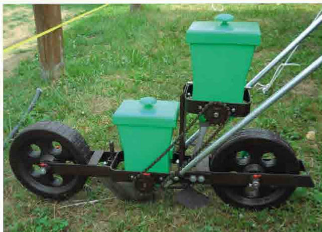
Pannongép K2 kézi vetőkocsi mikrogranulátum-kijuttató berendezéssel
