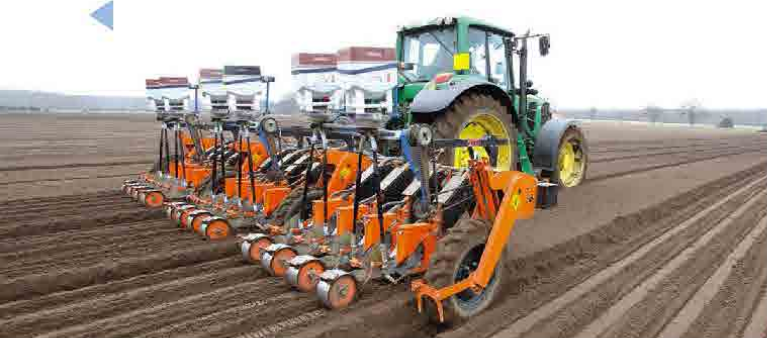
Microband mikrogranulátum-kijuttató berendezések Stanhay Star 3x4 soros kertészeti vetőgépen
