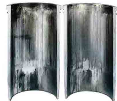
4. ábra. Hengerhüvely károsodás elégtelen kenési állapot esetén
