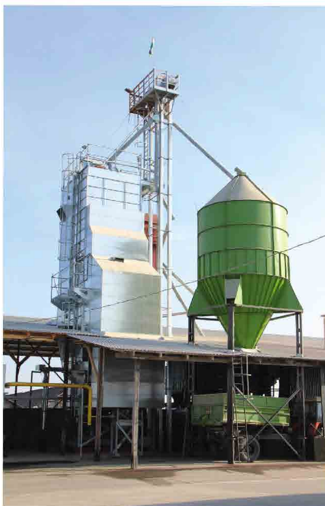
Tornum HR 3-16 folyamatos üzemű hő-visszaforgatásos terményszárító
