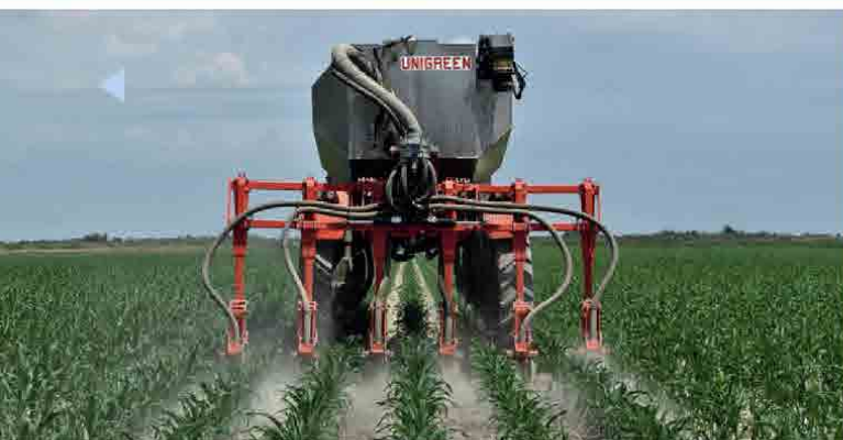
Unigreen Talpa önjáró eszközhordozó Maschio hígtrágya injektálással
