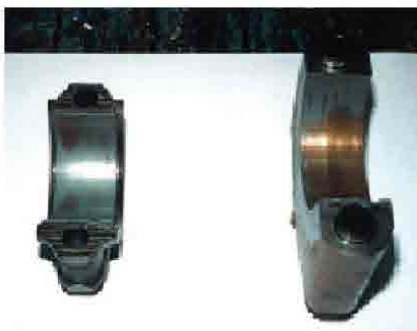
1. ábra: Csapágykárosodás elégtelen kenés miatt
