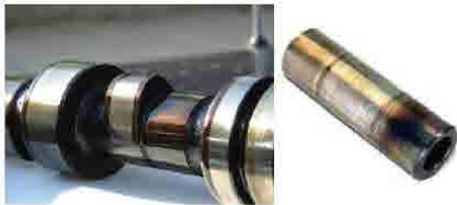
2. ábra: Vezérműtengely és dugattyúcsapszeg károsodása
