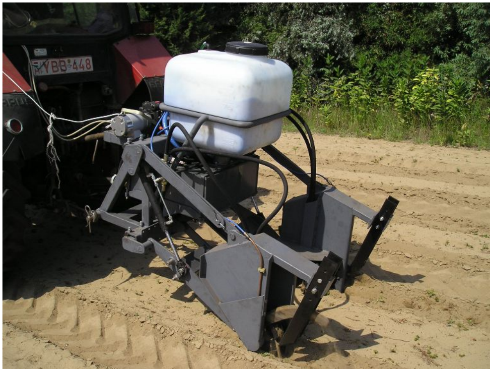
3. kép. A FIG-01 típusú forgókaros injektálógép
