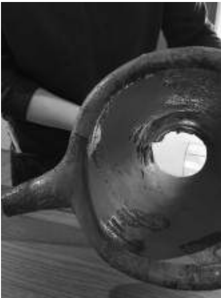
4. ábra: A sisak gyűjtőcsatornája és csöve (A szerző felvétele, 2018)
