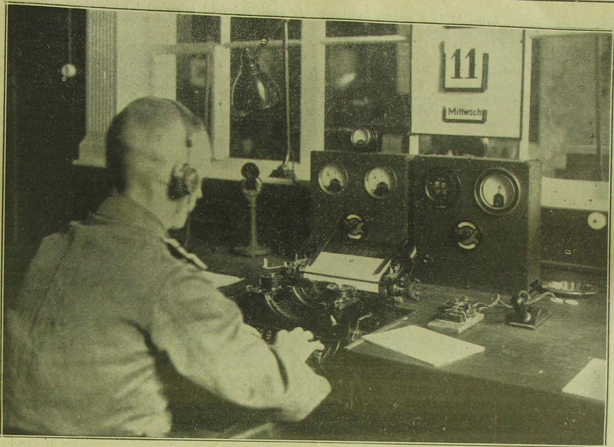
A berlini rendőrség rádió felvevő állomása. A rádión bemondott jelentést a kezelő hallgatás közben leírja.
