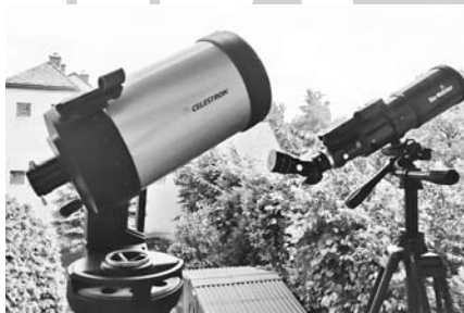
Cziniel Szabolcs leginkább használt távcsövei a képen látható 20 cm-es Schmidt-Cassegrain és egy 80/400 refraktor
