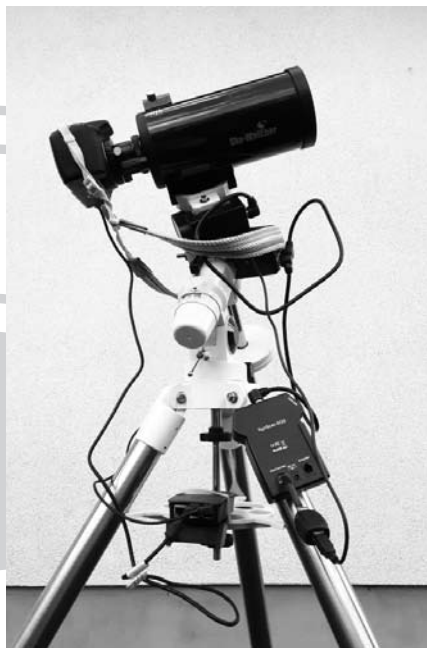
Az összeszerelt mechanika, a képről csak az áramellátásért felelős kábelek hiányoznak
