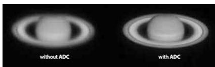
A Szaturnusz korrektor nélkül és korrektorral (a kép szélsőséges, de előforduló esetet mutat)
