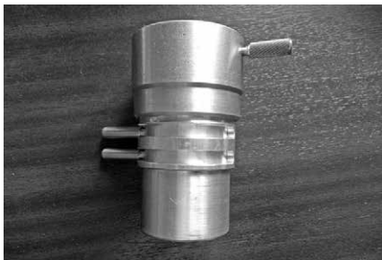
A korrekter összeszerelt állapotban. Jobbra fönt a sárgaréz rögzítőcsavar, amely az okulárt, vagy a kamerát fogja, balra pedig a forgatókarok, amelyekkel a prizmákat foglalatukkal együtt elforgathatók
