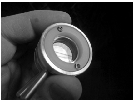
A foglalatokat egymásnak nyomó rugók a műanyaglappal, előlé kerül a 31,7 mm-es méretű okulárt vagy, kamerát befogadó fedél. Az alumínium nem jó csúszási tulajdonságokkal rendelkezik, így egy paraffingyertyával vékonyan megkentem a felületeket, kivéve a műanyag gyűrűvel érintkezőt
