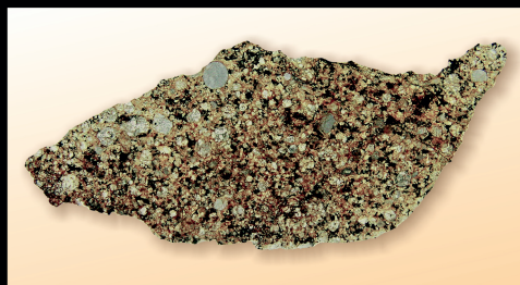
A meteorit körülbelül 20 mm-es vékonycsiszolatának síkpolarizált képe. Jól láthatók a kondulák kisebb-nagyobb kör alakú metszei. A sötét részek a fém és az átlátszatlan, úgynevezett opak ásványok
