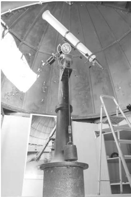
A csillagvizsgáló büszkesége, a 127/1450-es Reifelder-Hertel-refraktor. Súlyhajtású óragépe ma is hibátlanul működik
