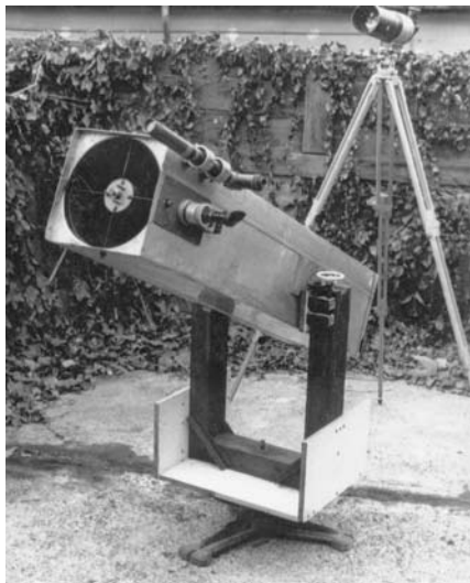
Papp Sándor (Pps) 24,4 cm-es reflektora 1982-ben. Az azimutális mechanika motorszerelő állványból készült (Újvárosy Antal felvétele)
