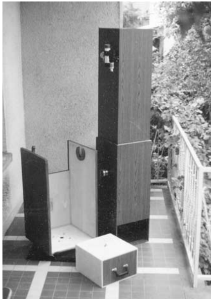
Becz Miklós bútortalapokból épített klasszikus felépítésű 29 cm-es Dobsonja (Becz Miklós felvétele)
