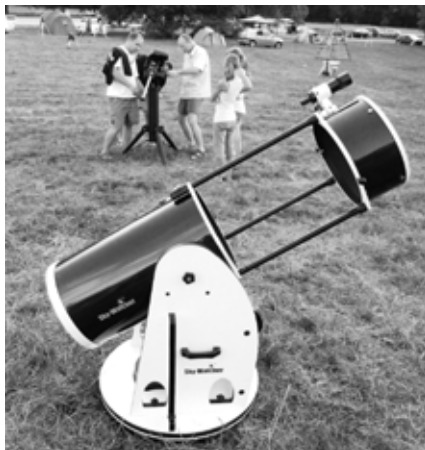
A SkyWatcher 35 cm-es GoTo Dobsonja a tarjáni észlelőreten (a szerző felvétele)
