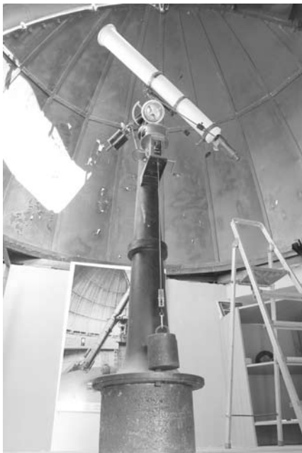
A csillagvizsgáló bűszkesége, a 127/1450-es Reifelder-Hertel-refraktor. Súlyhajtású órágepe ma is hibátlanul működik
