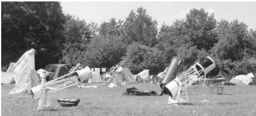
Magyarországra is megérkezett a Dobson-forradalom. Balra Horváth Marcell saját készítésű 30 cm-es Dobsonja, hátul az Odyssey-2, jobbra az MCSE frissen elkészült 38 cm-es Dobsonja, melynek tubusát és mechanikáját Horváth Marcell készítette. A felvétel az MTT 1997-en készült, Ágásváron (fotó: Mizser Attila)
